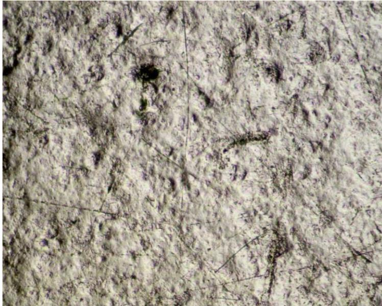
Figura 4.38 Estado de la superficie de la probeta 4 a 100x tras haberse concluido 400 ciclos. La película formada se presenta de forma más irregular que la anterior.
