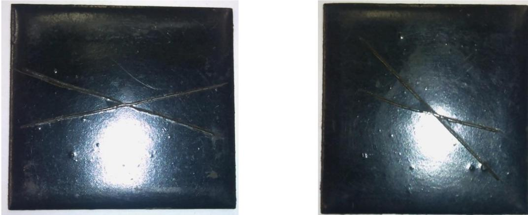
**Figura 4.52** Habiéndose completado los 500 ciclos de prueba se llevaron a cabo los ensayos de adherencia. Para ambas probetas, 2 y 3 respectivamente, no existe remoción alguna.
