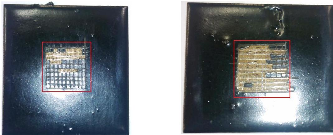
**Figura 4.51** Superficie restante al utilizar las incisiones en forma de cuadrícula, se observa una sensible diferencia de resultados entre la muestra de la izquierda (probeta 40) y la de la derecha (probeta 6). Al igual que las muestras de la figura anterior, éstas no fueron introducidas en ningún momento a los efectos de la cámara de atmósfera controlada.
