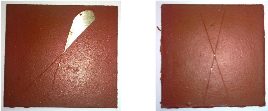
**Figura 4.45** Imágenes de las probetas 22 y 19 respectivamente, después de ser sometidas a 500 ciclos y generar el desprendimiento considerando cortes en “X”.
