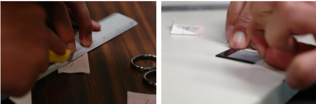
**Figura 3.9** Realización de los cortes –izquierda- y desprendimiento de la cinta adhesiva –derecha- ejecutados durante las pruebas de adherencia para los tres recubrimientos.
