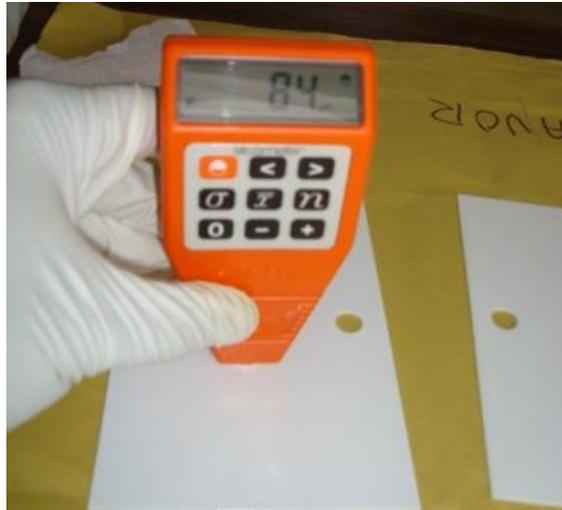
**Figura 3.2 Ejemplo de la obtención del espesor de recubrimiento para una probeta con cierto recubrimiento.**
