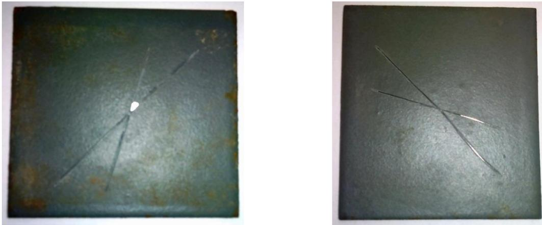
**Figura 4.48** Probetas, de izquierda a derecha, 36 y 14. Se notan muy ligeros desprendimientos para éstas al completarse el ensayo.
