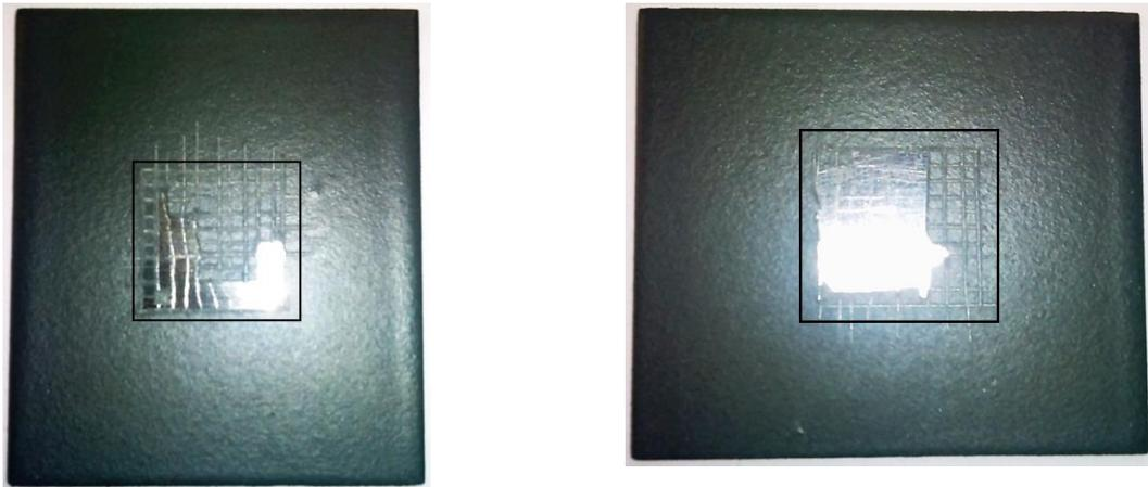
**Figura 4.47** Se ilustra lo obtenido al utilizar el corte en retícula para muestras sin ataque, esto para las probetas 13 y 15 respectivamente.
