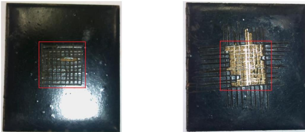
**Figura 4.53** Área restante de las probetas 42 (izquierda) y 4 (derecha), ambas sometidas a 500 ciclos, en donde existe una clara diferencia entre las rejillas desprendidas.
