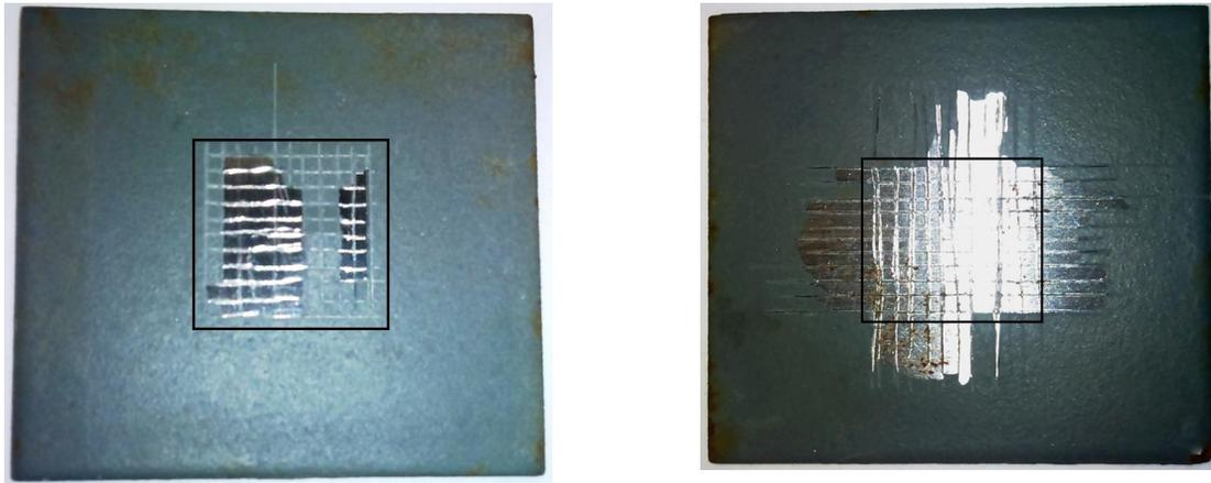
**Figura 4.49** Otras de las muestras que fueron sometidas a los 500 ciclos en CAPACA (número 9 a la izquierda y 38 a la derecha), evaluadas mediante el método alternativo usado para películas cuyo espesor no sobrepase las 50  $\mu\text{m}$ .
