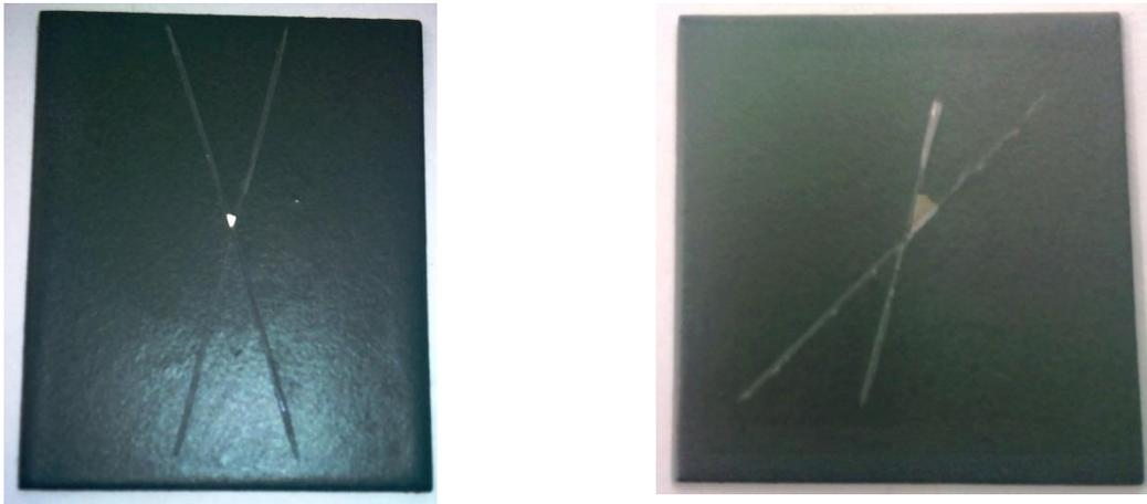
**Figura 4.46 Probetas 37 (izquierda) y 12 (derecha), con los cortes en “X”, ya que posee un espesor por arriba de las 125  $\mu\text{m}$  (en promedio 170  $\mu\text{m}$ ) antes de ser sometidas a cualquier sollicitación.**
