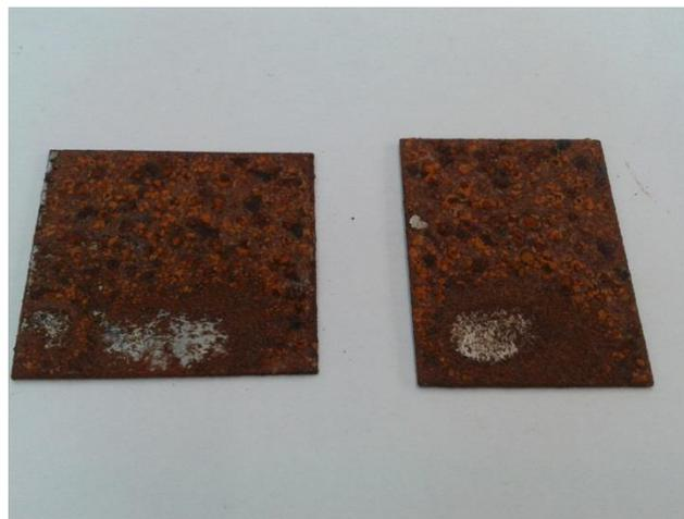
**Figura 4.41** Capa de herrumbre sobre el material del sustrato. Se nota la que tiene un espesor importante.
