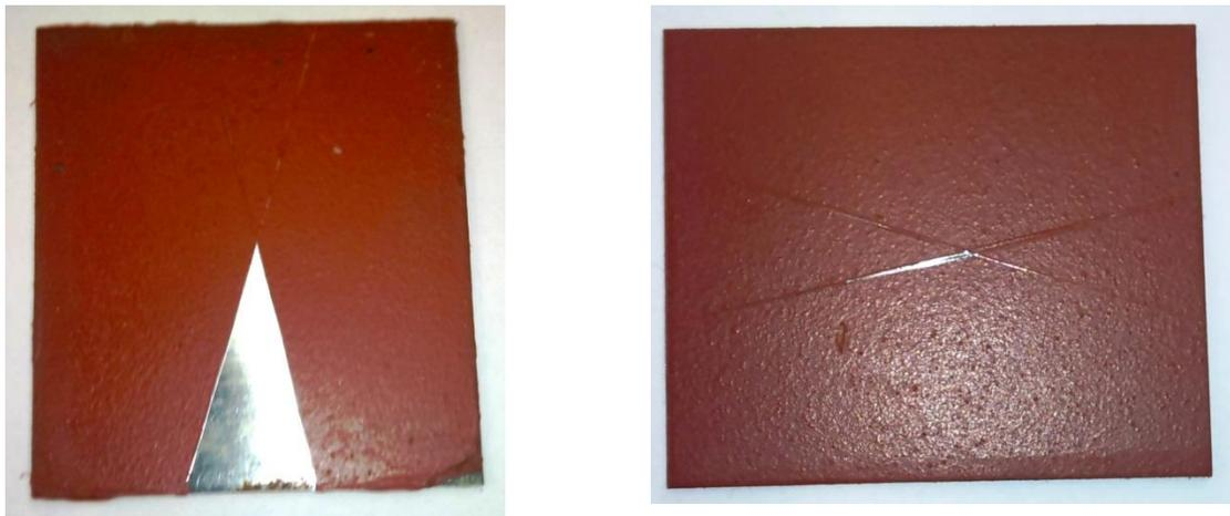
**Figura 4.43** Considerando la técnica con un corte en “X”, considerando que no es la técnica recomendada para el espesor promedio de esta pintura (aproximadamente 43  $\mu\text{m}$ ). Se muestran los resultados para muestras sin ataque (probeta 26 y 24 respectivamente).
