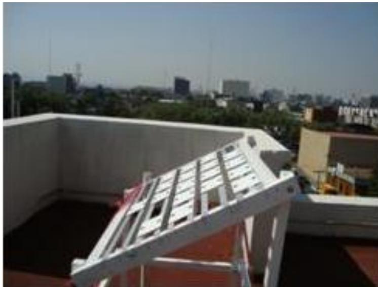
**Figura 2.3 Rack de exposición atmosférica para recubrimientos (orientado hacia el sur e inclinado 30° sobre la horizontal).**
