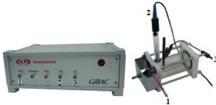
**Figura 3.3 Potenciostato y una de las celdas electroquímicas utilizadas con sus respectivas conexiones, donde: 1. Electrodo de trabajo, 2. Electrodo de referencia, 3. Electrodo auxiliar.**
