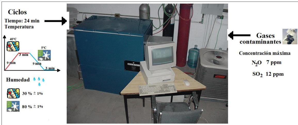
**Figura 3.8** Se indican las variables para la degradación de recubrimientos orgánicos dentro de la cámara de pruebas aceleradas de corrosión atmosférica (CAPACA).
