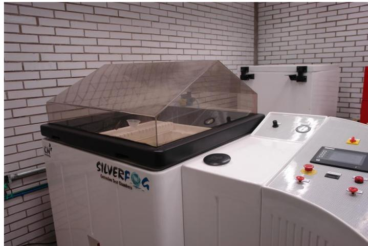
**Figura 2.2** Cámara de niebla salina comercial capaz de efectuar diversos ensayos estandarizados.
