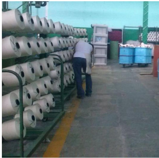
Figura 3.7 Bobinas o husadas de plástico con hilo crudo. Fotografía capturada por la autora.
