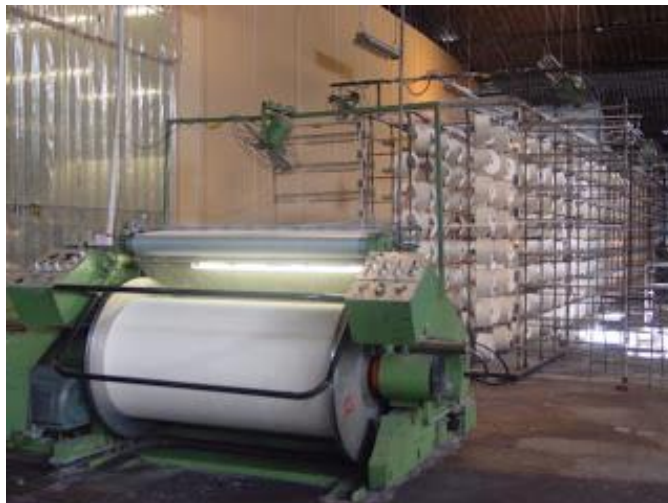
Figura 3.13 Máquina urdidora directa, al fondo se observa una fileta con canillas de plástico envueltas con hilo crudo. Fotografía capturada por la autora.
