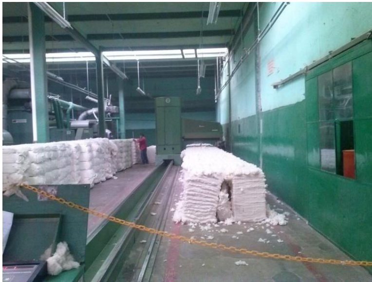
Figura 3.4 Máquina blendomat encargada de realizar la apertura del proceso de hilatura. Fotografía capturada por la autora.
