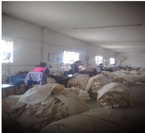
Figura 3.26 Tela cortada transversalmente dispuesta en pequeños lotes para someterla posteriormente a la costura lineal y transversal en la empresa de confección. Fotografía capturada por la autora.
