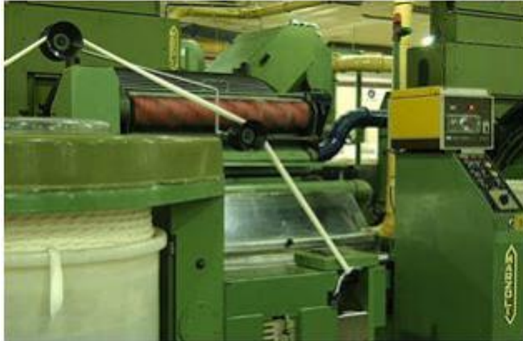
Figura 3.5 Máquina cardadora que realiza la operación de selección de fibras largas hasta obtener una cinta de fibras (como la que se observa en la imagen) unidas con base al principio de centrifugación. Fotografía capturada por la autora.
