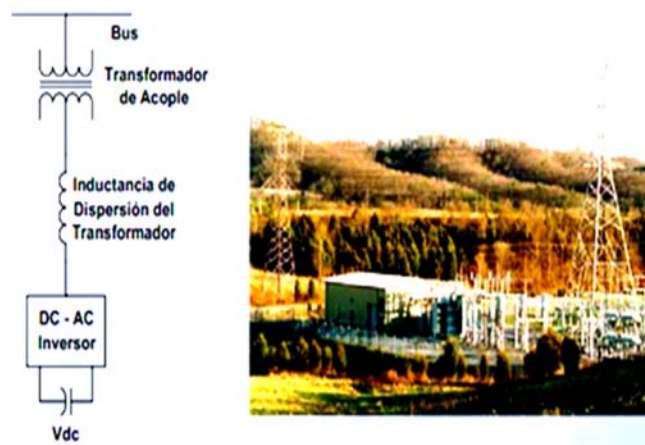
Figura 22b. Diagrama y foto de la aplicación basada en convertidor de fuente de Voltaje VSC.
