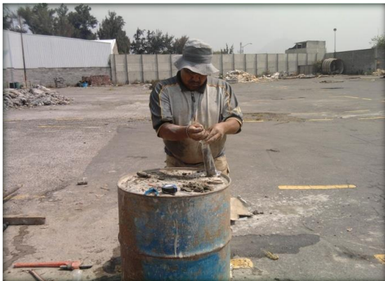
MOMENTO EN QUE ES CLASIFICADA Y EMPACADA MUESTRA ALTERADA OBTENIDA CON EL MUESTREADOR TIPO TUBO PARTIDO.
