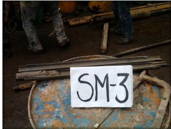
VISTA DE MANIOBRA DE DESACOPLAMIENTO DEL TUBO PARTIDO PREVIO A LA EXTRACCIÓN DE MUESTRA ALTERADA RECUPERADA OBTENIDA.
