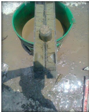
MUESTRAS REPRESENTATIVAS ALTERADAS OBTENIDAS A DIFERENTES PROFUNDIDADES CON EL MUESTREADOR TIPO TUBO PARTIDO.
