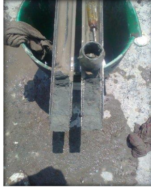
MUESTRAS REPRESENTATIVAS ALTERADAS OBTENIDAS A DIFERENTES PROFUNDIDADES CON EL MUESTREADOR TIPO TUBO PARTIDO.
