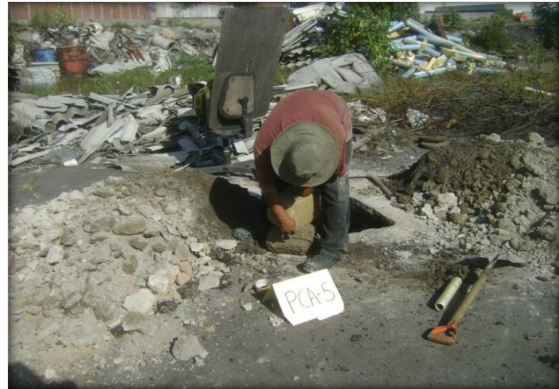
MUESTRA CUBICA REPRESENTATIVA INALTERADA MOMENTOS EN QUE ES LABRADA Y EMPACADA PARA SER TRASLADADA AL LABORATORIO CENTRAL.
