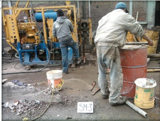
VISTA DE MANIOBRA DE DESACOPLAMIENTO DEL TUBO PARTIDO PREVIO A LA EXTRACCIÓN DE MUESTRA ALTERADA RECUPERADA OBTENIDA.
