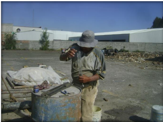
INSPECCION, CLASIFICACIÓN Y REGISTRO DE LOS MATERIALES ENCONTRADOS SONDEO MIXTO SM-2.
