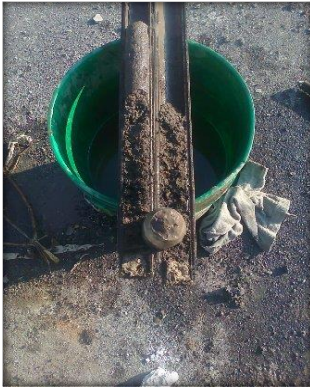
MUESTREADOR DE PARED DELGADA (TUBO SHELBY). SONDEO MIXTO SM-1.
