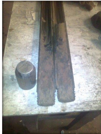
MUESTRA REPRESENTATIVA ALTERADA OBTENIDA CON EL MUESTREADOR TIPO TUBO PARTIDO.
