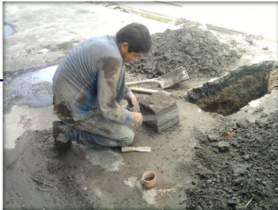
PCA No.6.- MUESTRA CUBICA INALTERADA. LABRADA Y EMPACADA PARA SER TRASLADADA AL LABORATORIO CENTRAL.
