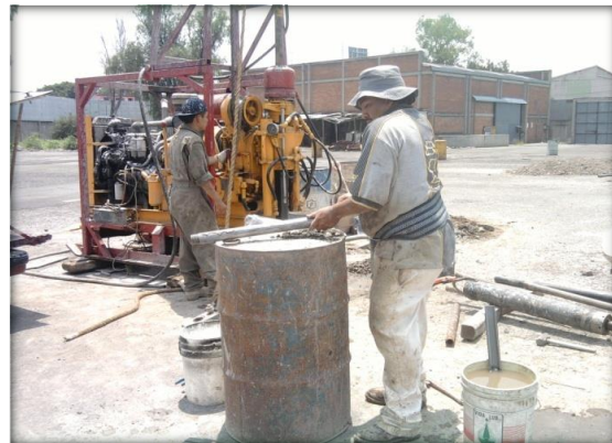
MOMENTO EN QUE ES CLASIFICADA Y EMPACADA MUESTRA ALTERADA OBTENIDA CON EL MUESTREADOR TIPO TUBO PARTIDO.
