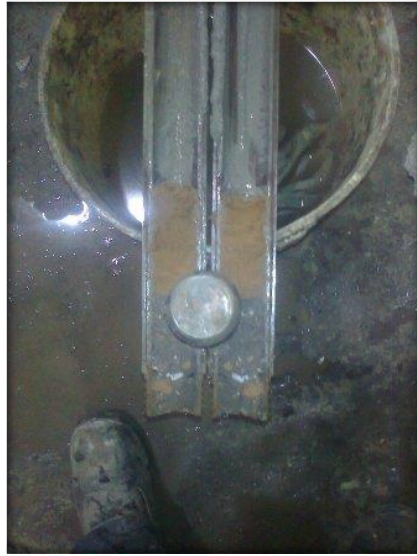
MUESTRAS REPRESENTATIVAS ALTERADAS OBTENIDAS CON EL MUESTREADOR TIPO TUBO PARTIDO (SONDEO DE PENETRACIÓN ESTANDAR SPT-6).
