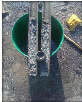
MUESTRAS REPRESENTATIVAS ALTERADAS OBTENIDAS A DIFERENTES PROFUNDIDADES CON EL MUESTREADOR TIPO TUBO PARTIDO.
