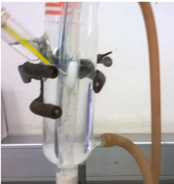
Figura 23. Aparato para medir el tiempo de licuefacción de supositorios rectales.
