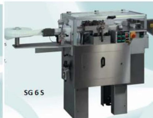
Figura 18. Línea de producción de supositorios SARONG SL6, empleada para la fabricación automatizada de supositorios con las unidades individuales 39 .
