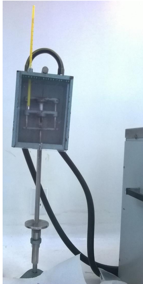
Figura 25. Aparato utilizado para determinar la resistencia mecánica de los supositorios 11 .
