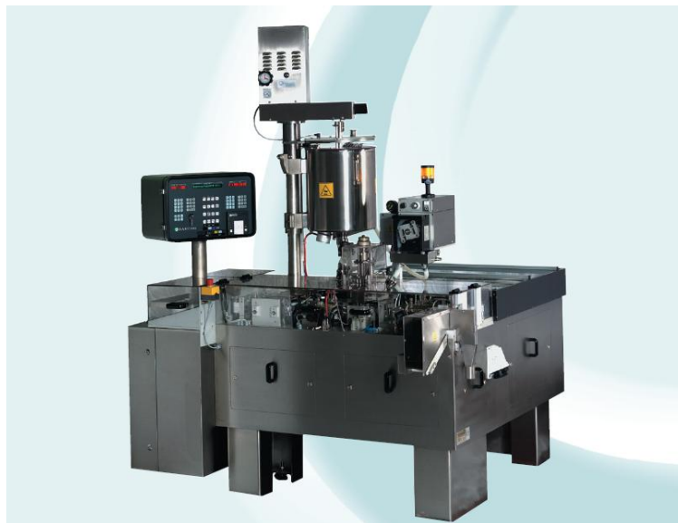
Figura 15. Producción automatizada a gran escala de supositorios preparados y envasados en tiras 39 .
