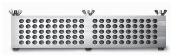
Figura 13. Molde para supositorio, con este molde es posible producir 50 supositorios en forma de torpedo en un solo moldeo 11 .
