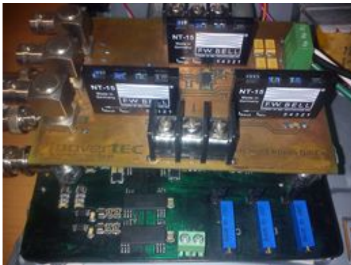
Figura 3.10: Tarjeta de medición de corrientes
