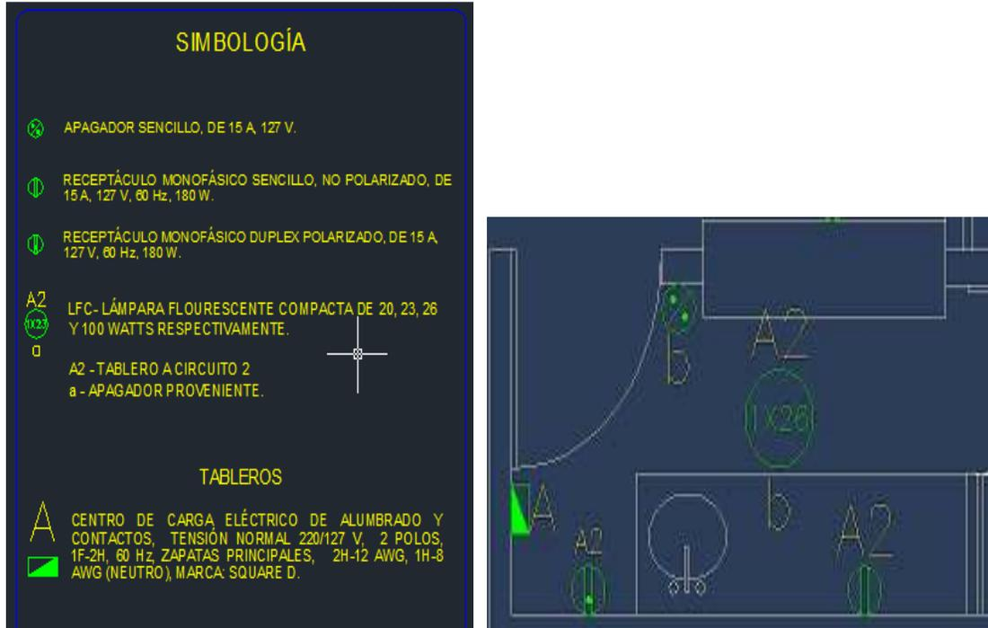
Por ejemplo, en la siguiente figura se muestra una de las lámparas, ésta es una lámpara fluorescente compacta de 26 Watts y 127 volts la cual está conectada al circuito dos del centro de carga A y que prende al accionar el apagador identificado con la letra b. Todas estas características ya vienen incluidas en sus atributos desde el programa mismo.
