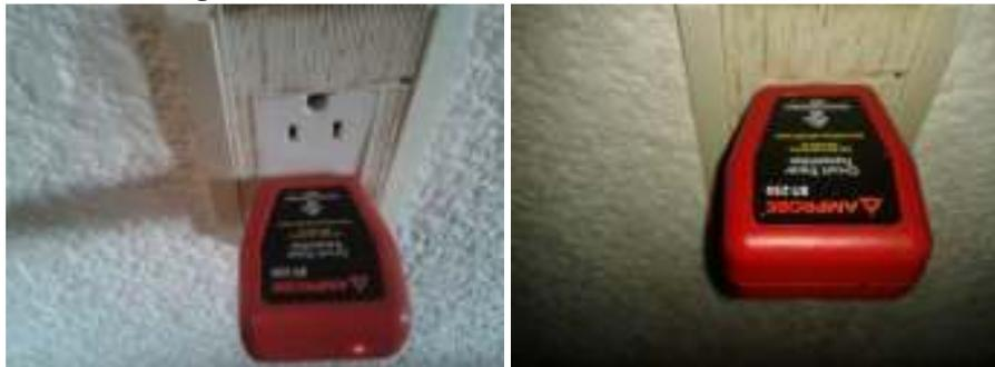
Ocurre lo mismo para la identificación de las lámparas, se conecta el trazador al que parece clavija de foco (foto del material) y se conecta como si fuera el foco y así a cada uno para poder saber a qué circuito van todas las lámparas.
