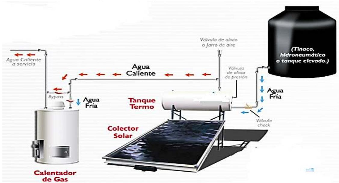
Este tipo de equipos pueden estar conectados con el calentador de gas tradicional y así usarlo en caso de que el colector solar no cubra las necesidades de ese día. Así se tendrá agua caliente en cualquier momento y estación del año.
