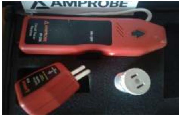
Aquí por ejemplo se conecta el trazador en un contacto de la casa y con el receptor se ubica la señal en el centro de carga para saber de qué circuito viene, en estos casos solo hay dos circuitos.
