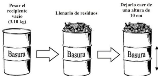
Figura 2. Secuencia para obtener el peso volumétrico "in situ".
