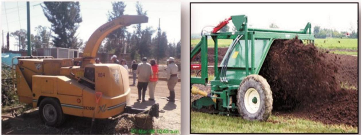
Figura 18. Trituradora de materia orgánica y mezcladora de composta
