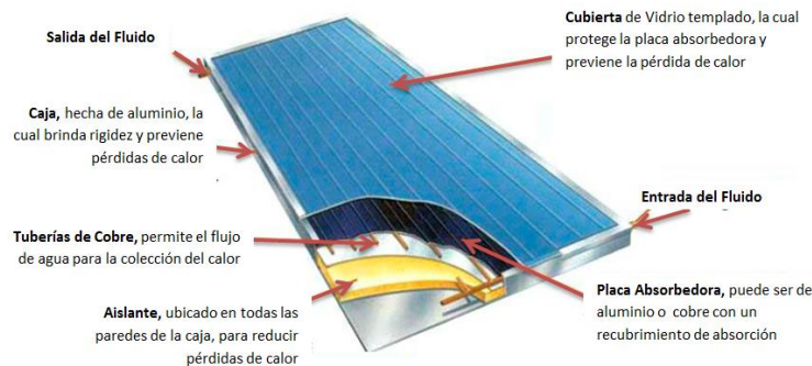
Figura 1.1 Composición del colector de placa plana [1]
