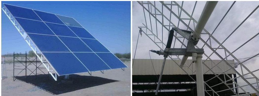
Figura 2.18: Helióstato UNISON-TX-H36 (izquierda) y transmisiones de movimiento (derecha).
