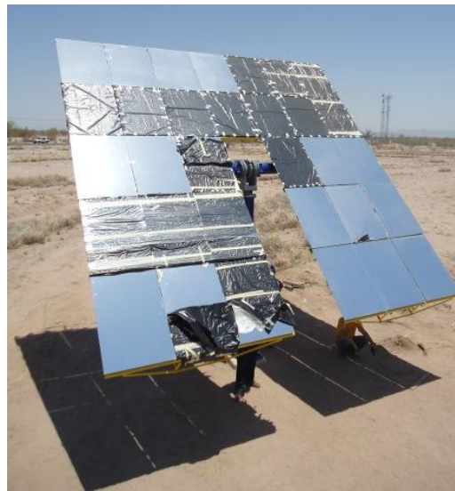
Figura 4.7: Heliostato parcialmente canteado.
