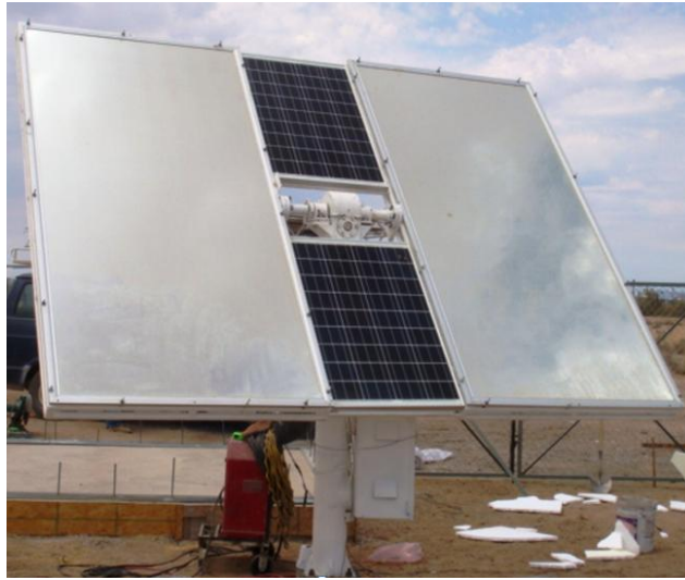
Figura 2.16: Heliostato UNISON-TxTec H6.
