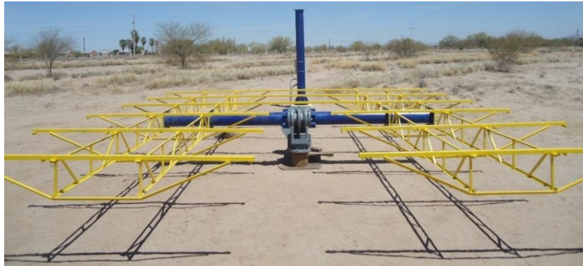
Figura 4.1: Ensamble estructural del heliostato.
