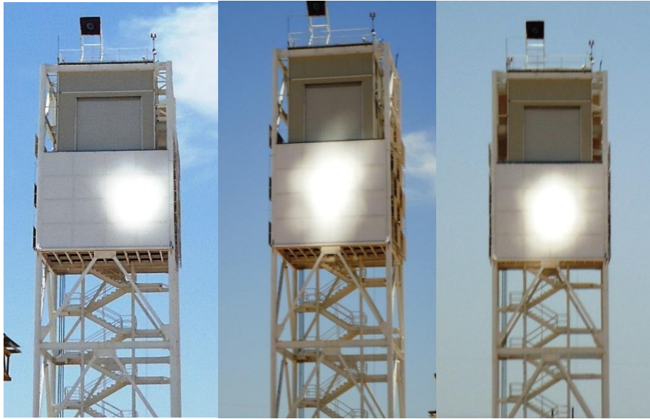
Figura 6.9: (a) 15 facetas canteadas y las demás cubiertas, (b) todas las facetas descubiertas incluyendo las 17 no canteadas, (c) todas las facetas canteadas.
