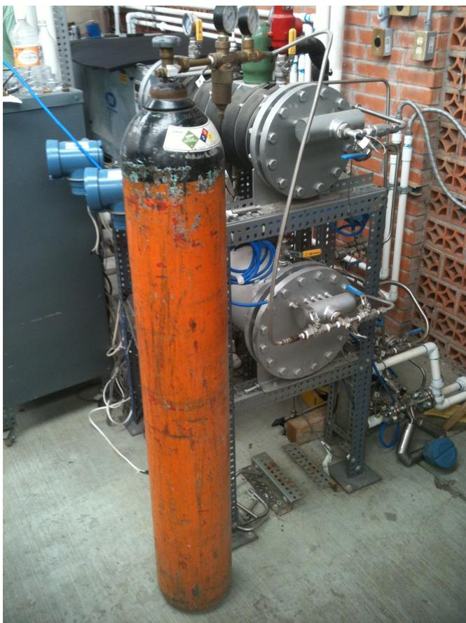
Figura 3.11: Presurizado del sistema usando nitrógeno.
