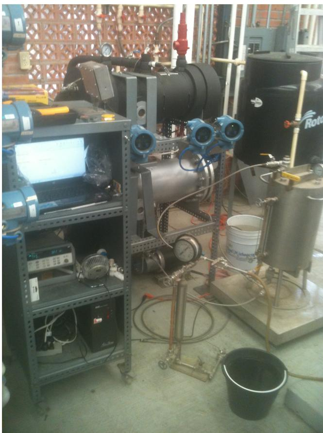
Figura 3.13: Carga de la mezcla  $NH_3 - LiNO$  al equipo de absorción.
