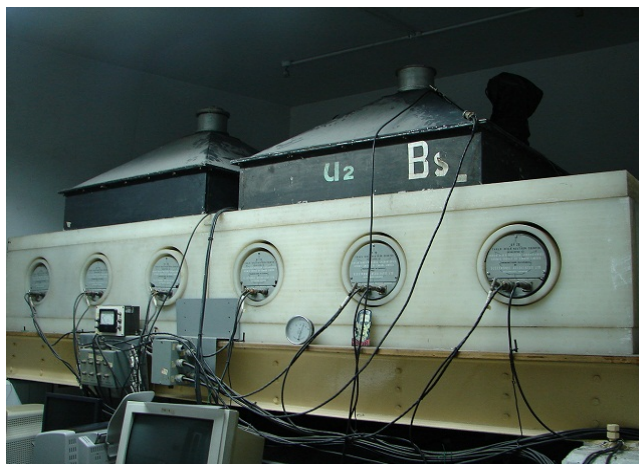
Figura 3.1: Monitor de Neutrones 6-NM64 instalado en el Observatorio de Rayos C3smicos en Ciudad Universitaria
