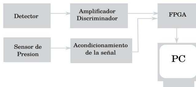
Figura 3.5: Diagrama a bloques del sistema de adquisición de datos del observatorio de CU
