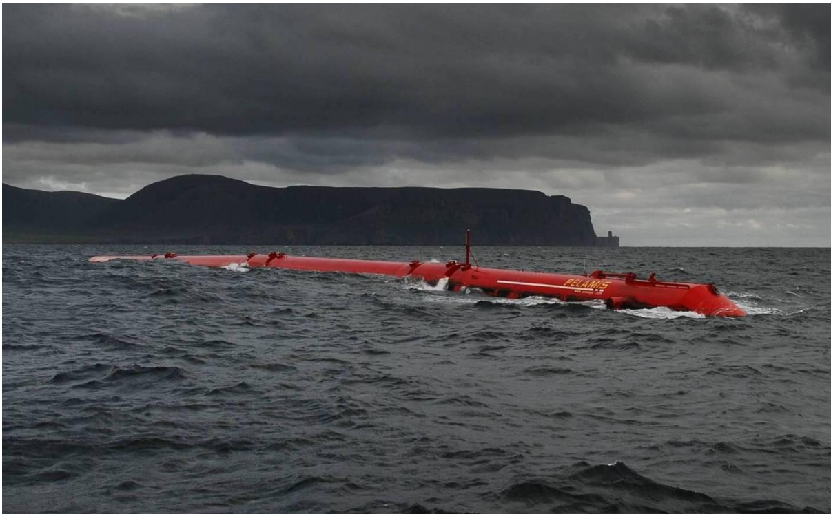
Figura 1.17 El convertidor de olas Pelamis emplea el movimiento del oleaje oceánico para la generación de energía eléctrica.
