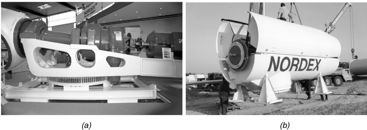
Figura 3.22 La góndola de un aerogenerador.
