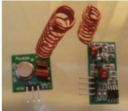
**Figura 4.30. Módulos de RF con sus respectivas antenas.**
