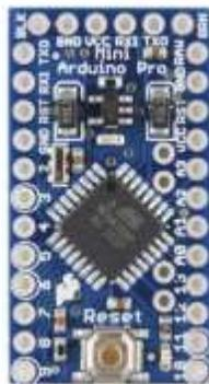
**Figura 4.34. Tarjeta Arduino Pro-Mini con micro-controlador ATmega328 [62].**
