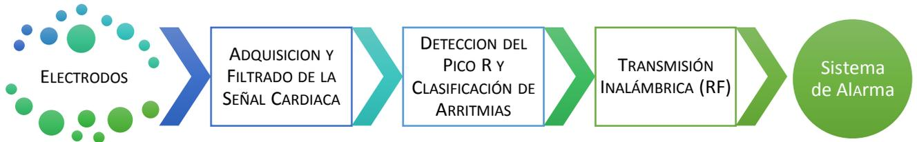
**Figura 1.1. Diagrama del sistema propuesto.**
