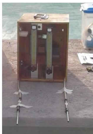
Figura 9. Rack de muestreo utilizado en las campañas de monitoreo.
