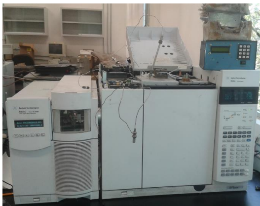
Figura 17. Cromatógrafo de gases marca Agilent Technologies modelo 7890AGC System acoplado a un espectro de masas Agilent 5975C.
