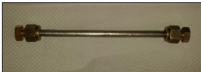
Figura 12. Cartucho acondicionado y tapado con férulas de teflón y tapas marca Swagelok de ¼ de pulgada.
