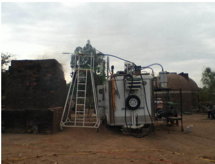
Figura 39. Muestreo de emisiones de horno de ladrillos con sistema de dilución de grupo FQA.
