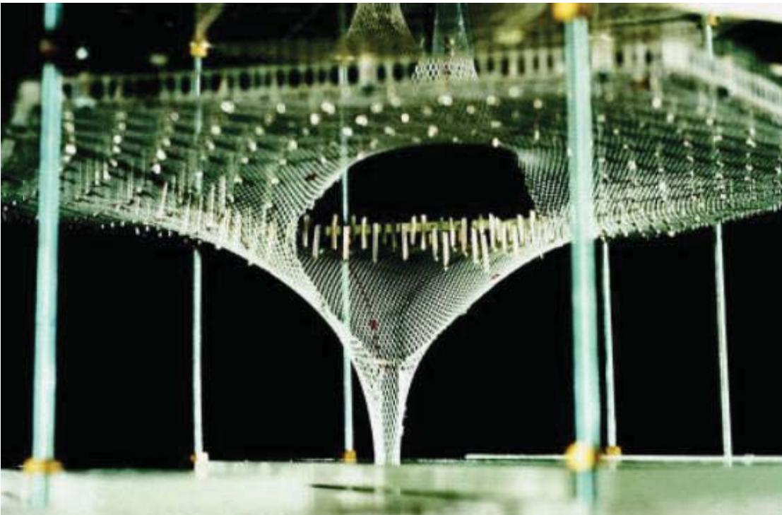
Maqueta experimental con membranas red de tul tensada. Frei Otto. [techsem.ocular-witness.com](http://techsem.ocular-witness.com) Img.25
