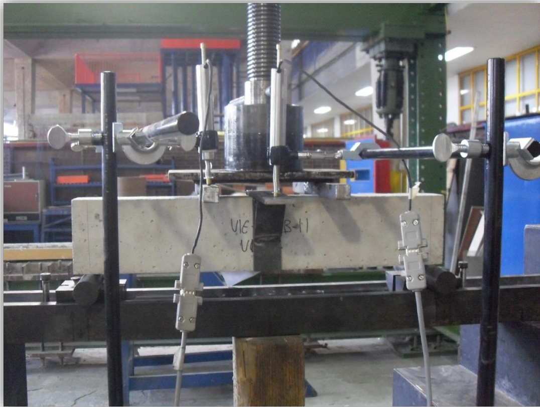
Figura 6.2.4.3 Preparación de la instrumentación del ensaye de la viga VCS4
