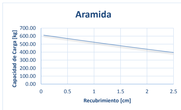
Figura 6.6f Sensibilidad del recubrimiento en la capacidad de carga por flexión de las vigas planteadas reforzadas con aramida
