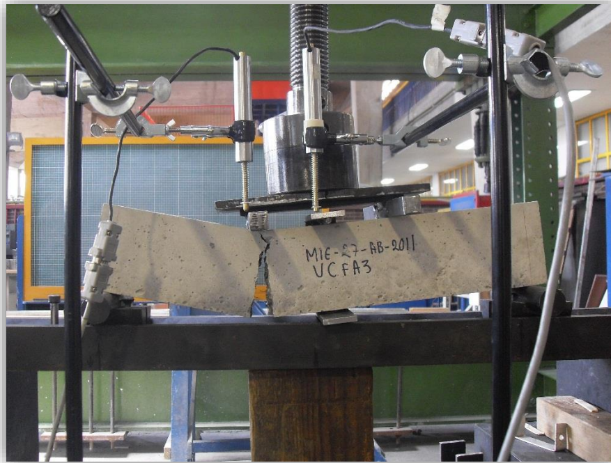
Figura 6.3.3.3a Falla del elemento después de la aplicación de la carga máxima de la viga VFA3
