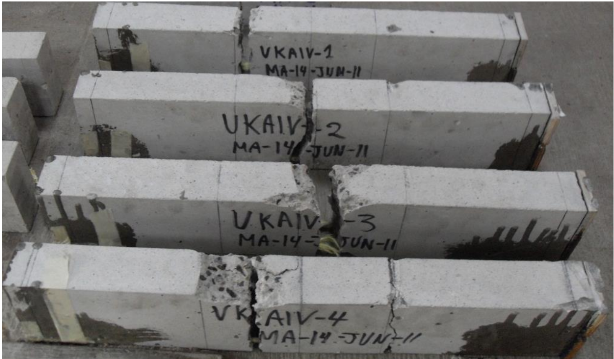
Figura 6.5.5 Localización de las fallas de las vigas de concreto reforzado con aramida
