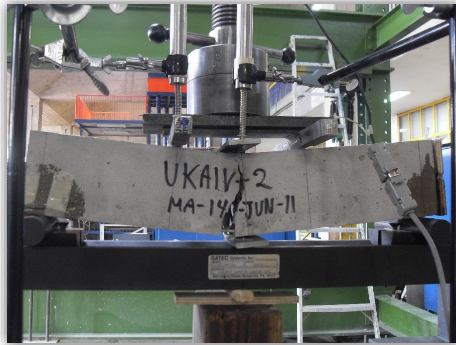
Figura 6.5.2.3a Falla del elemento después de la aplicación de la carga máxima de la viga VFK2
