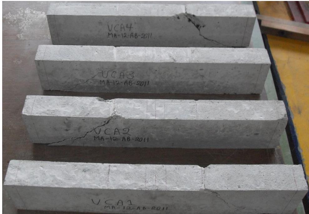
Figura 6.4.5 Localización de las fallas de las vigas de concreto armado
