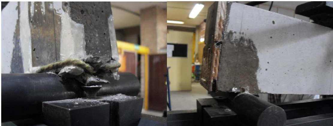
Figura 6.5.1.3b Falla del elemento después de la aplicación de la carga máxima de la viga VFK1
