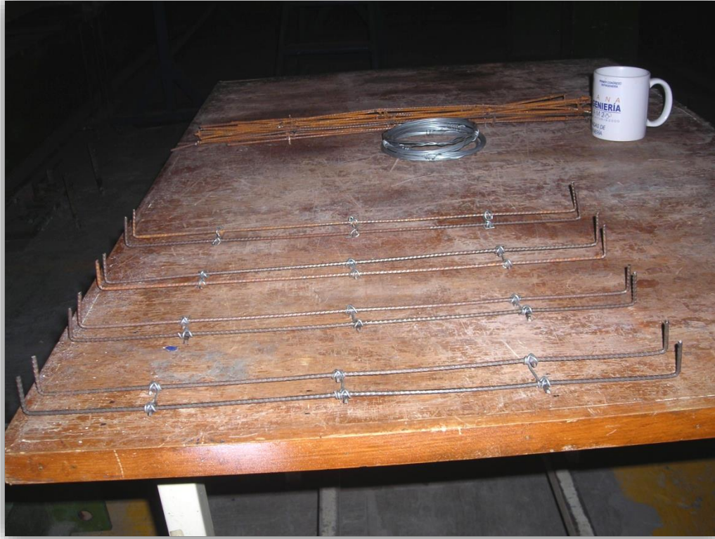
Figura 5.6.1a Alambres corrugados cortados de la malla electrosoldada
