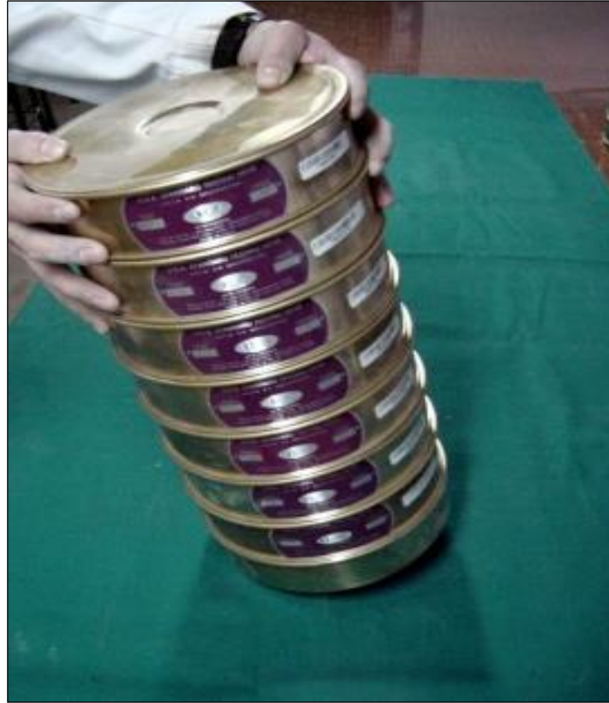
Figura 4.1.4a Arreglo de mallas para determinar el MF de la arena
