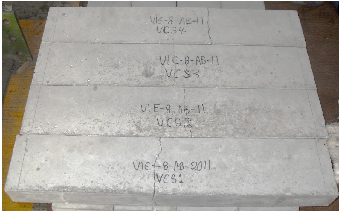
Figura 6.2.5 Localización de las fallas de las vigas de concreto simple
