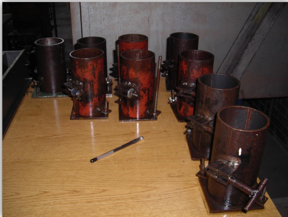
Figura 5.1 Cimbras para elaborar los cilindros de concreto ensayados en el laboratorio
