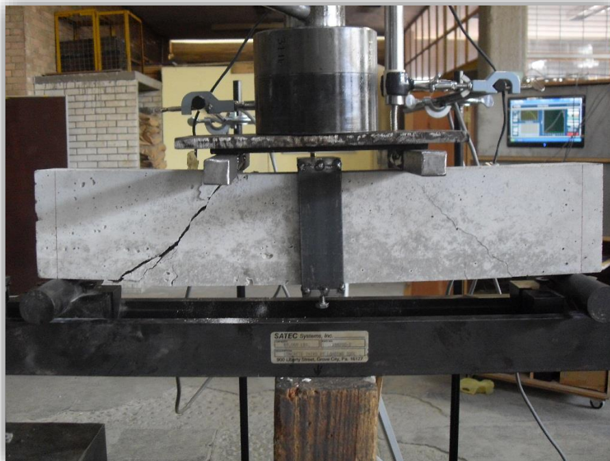
Figura 6.4.4.3b Falla del elemento después de la aplicación de la carga máxima de la viga VCA4
