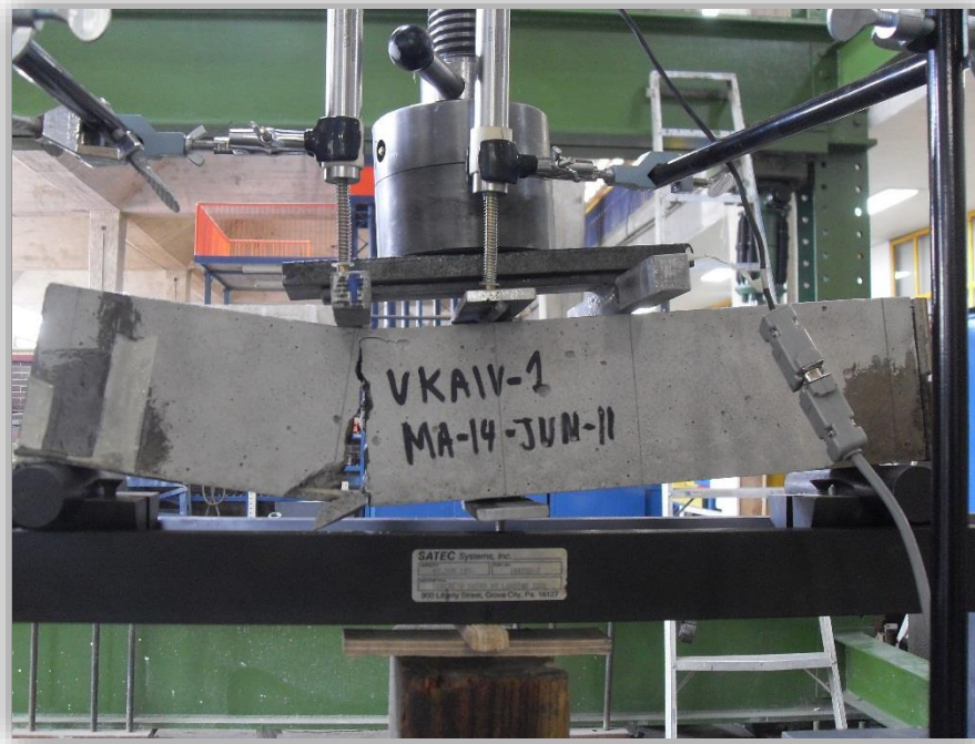
Figura 6.5.1.3a Falla del elemento después de la aplicación de la carga máxima de la viga VFK1
