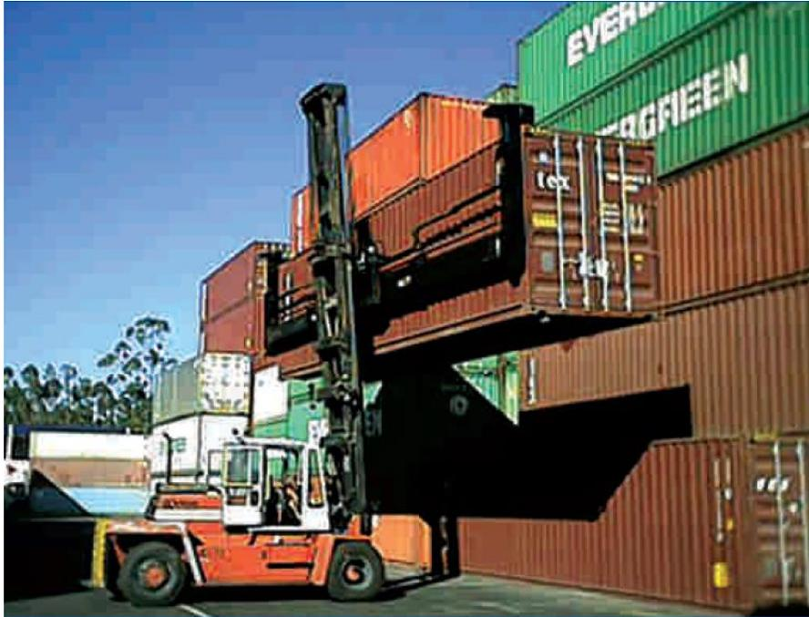
**Figura 4.21** Spreader telescópico para contenedor
