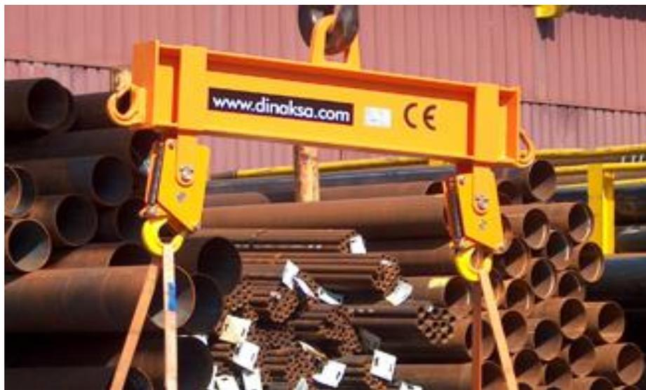
**Figura 4.36 Balancines en funcionamiento**
