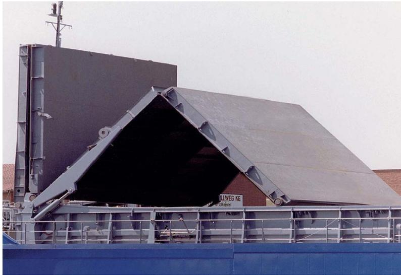
**Figura 4.12 Tapa de escotilla para buques de carga**
