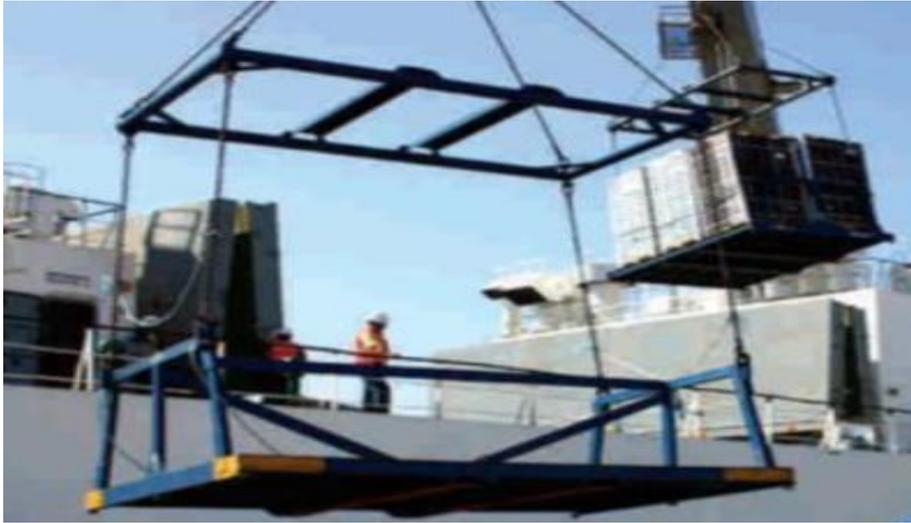
**Figura 4.39** Plataforma para carga general
