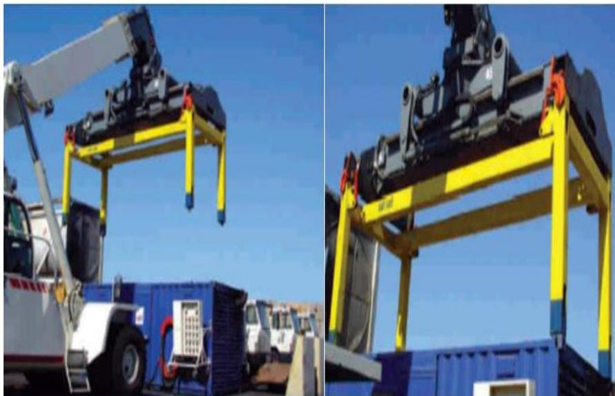
**Figura 4.22** Spreader telescópico Open Top
