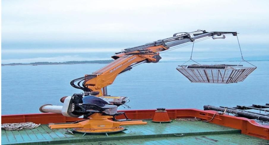
**Figura 4.42 Grúa Hidráulica**
