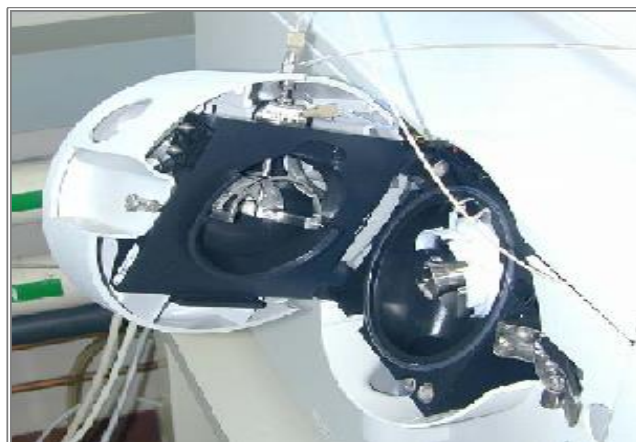
Fig. 4. Interfase por electrospray (ESI) de un detector de masas triple cuadrupolo. 5
