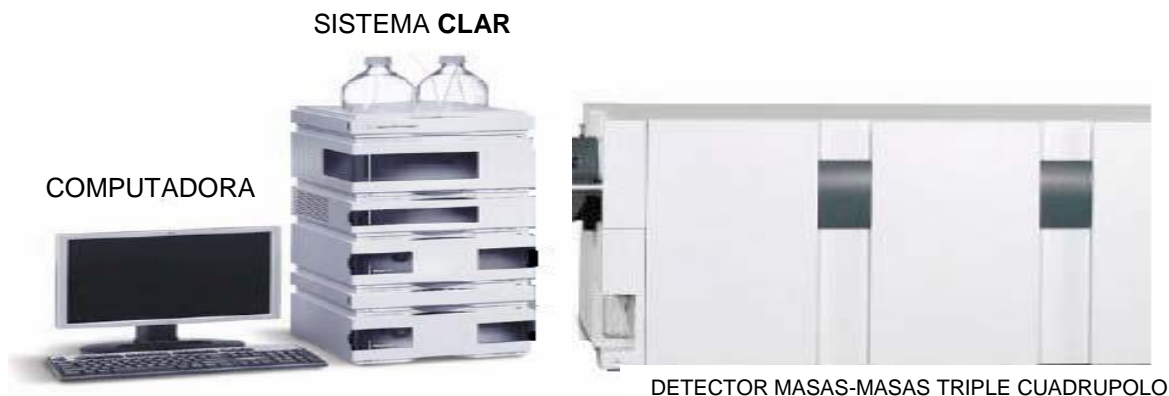
Fig. 3. Sistema de cromatografía de líquidos de alta resolución acoplado a un detector de masas. 5
