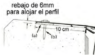
Figura B.146c – REMATE DE PRETIL DE DURALUMINIO donde se busca ocultar el remate en el lado de la fachada.
