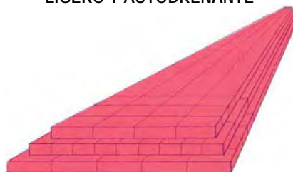
Figura B.19c - DISPOSICIÓN DE BLOQUES RECOMENDADA
