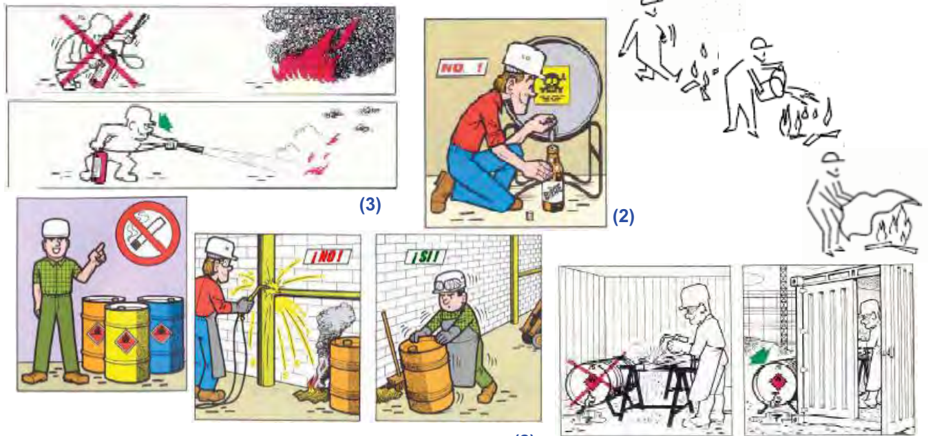
Figura A.13 – PREVENCIÓN CONTRA INCENDIOS Y EXPLOSIONES
