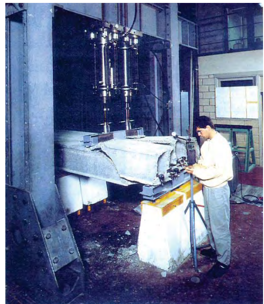
Fig. A.21h -Prueba al estado límite de esfuerzo cortante para losas alveolares de concreto presforzado - Imagen tomada del Reporte de actividades — CERIB 1991 - p.11
