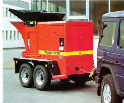
Molinos trituradores con neumáticos para su fácil transporte
