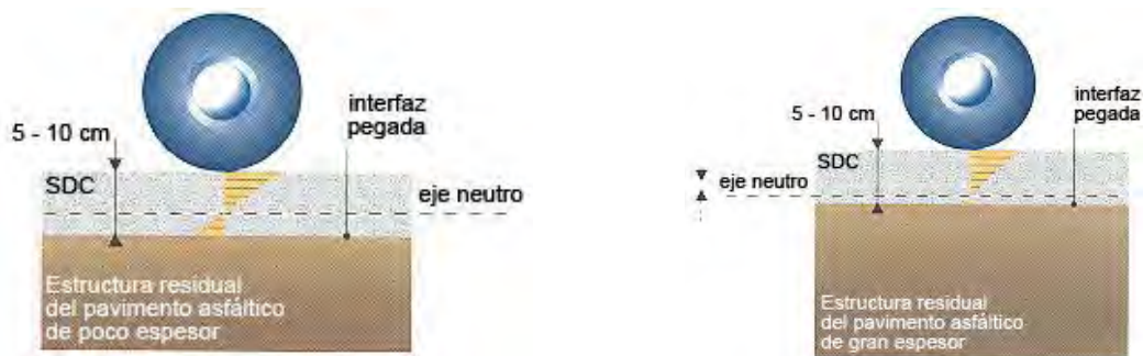
Figura B.783 – INFLUENCIA DEL ESPESOR RESIDUAL DE LA ESTRUCTURA DEL PAVIMENTO ASFÁLTICO A CUBRIR POR LA SOBRECAPA DELGADA DE CONCRETO (SDC). Entre mayor sea el espesor de la estructura residual del pavimento de asfalto más se desplazará hacia abajo el eje neutro y, por tanto, más se reducirán los esfuerzos de tracción en la base de la sobrecapa delgada de concreto.
