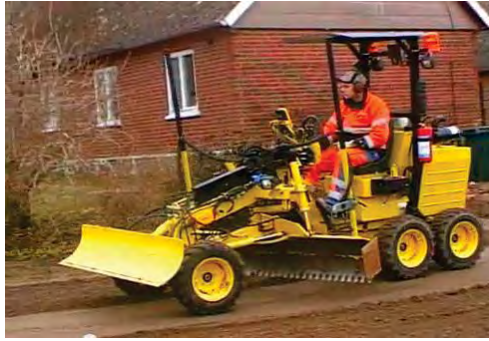
Figura A.137 – MINI-NIVELADORA Laser-Grader. Es un equipo que por su reducido tamaño es más fácil de utilizar y más económico que una motoconformadora normal para la realización de nivelaciones de bases de plataformas de vivienda, de andadores y banquetas y de vialidades y áreas de estacionamiento y canchas deportivas de conjuntos habitacionales. Pesa 1.5 ton. y su cuchilla inferior tiene 2.00 m y nivela el suelo con una precisión inferior a un centímetro. – Fuente. Catálogo de producto, empresa PAYEN.
