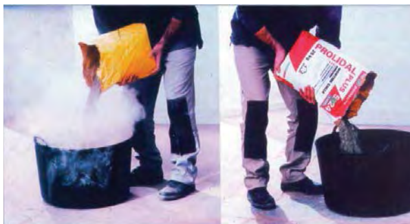
Figura C.149 – COMPARACIÓN ENTRE CEMENTOS TRADICIONALES MUY PULVERULENTOS Y CEMENTOS DE NUEVA GENERACIÓN SIN CREACIÓN DE POLVO VOLÁTIL
