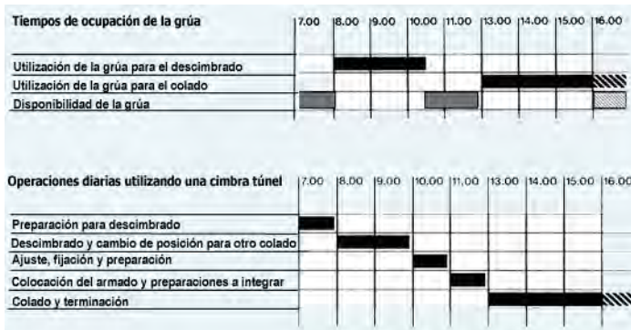
Figura A.247b – PROGRAMACIÓN DE CARGA DE TRABAJO DE UNA GRÚA ACORDE CON LAS OPERACIONES DIARIAS DE COLADO - Fuente : Folleto publicitario de la empresa OUTINORD
