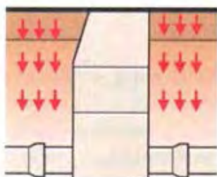
Figura B.536a – El relleno y la compactación se efectúan en capas sucesivas de la misma manera que en el caso de rellenos de trincheras de tubería.
