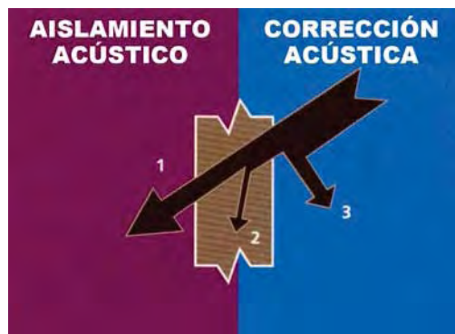
Figura C.92 – (1) TRANSMISIÓN, (2) ABSORCIÓN Y (3) REFLECCIÓN DE UN SONIDO POR UNA PARED Fuente: Catálogo Manual Técnico Nuit et Jour, les solutions contre le bruit. Empresa FIBRAVER, 1993, p. 9
