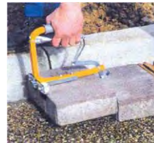
Figura A.178b – COLOCADORES MANUALES DE ADOQUINES DE CONCRETO
