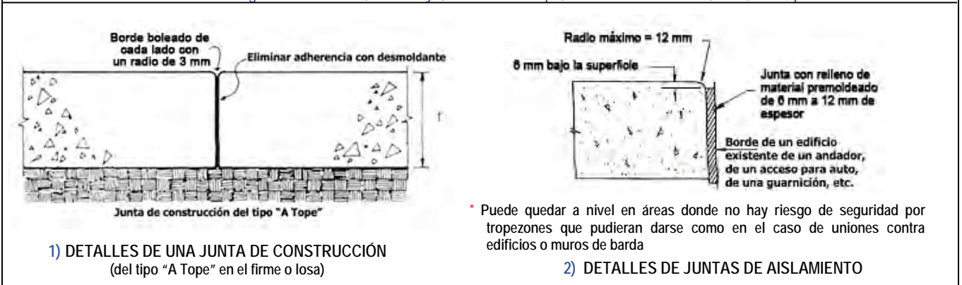
Figura B.612b – TIPOS DE JUNTAS EN PAVIMENTOS DE CONCRETO (aplicables a banquetas y andadores)
