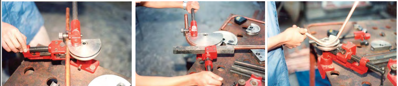
Figura B.245 – PROCESO DE ABOCINADO (ACAMPANADO) para evitar el uso de coples y nipples de unión
