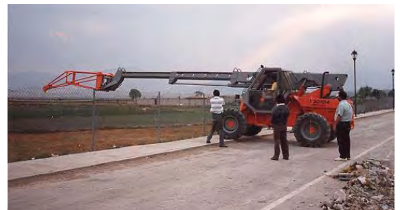
8.- ALCANCE HORIZONTAL MÁXIMO DEL BRAZO con aguilón como accesorio.
