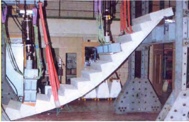
Fig. A.21a - Ensayo de escalera de concreto armado - Imagen tomada del Informe Anual 2000 - CERIB – p. 8
