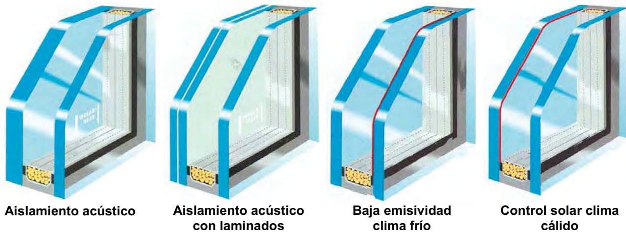
Figura B.332 – EJEMPLOS DE DIFERENTES OPCIONES DE DOBLE VIDRIO EN VENTANAS O TRAGALUCES DEPENDIENDO DE LAS NECESIDADES ESPECÍFICAS Y LOS RECURSOS PARA UN PROYECTO DADO
