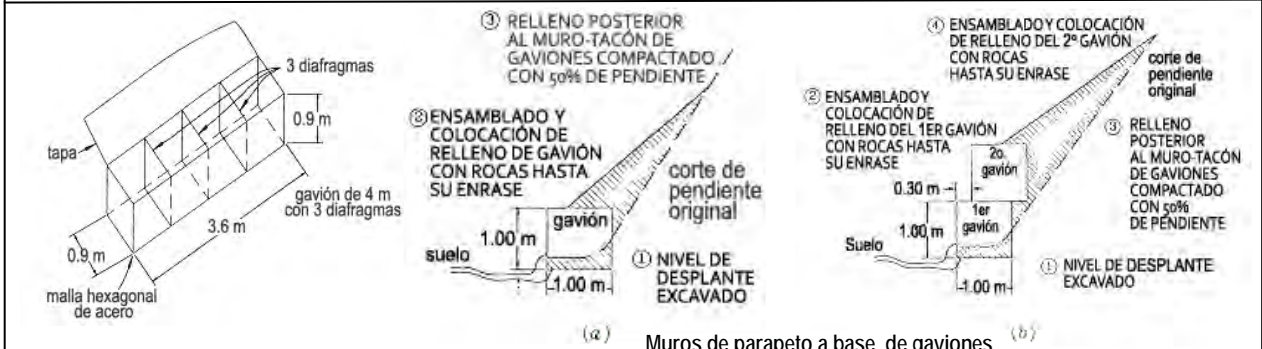
Figura B.9c – MURO-TACÓN BAJO DE CONTENCIÓN. Se muestra la secuencia de excavación, ensamble y llenado. (a) Hilada sencilla. (b) Hilada doble
