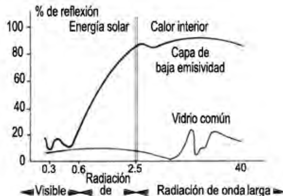
Figura B.325 - LA CAPA DE BAJA EMISIVIDAD REFLEJA LA RADIACIÓN INFRARROJA
