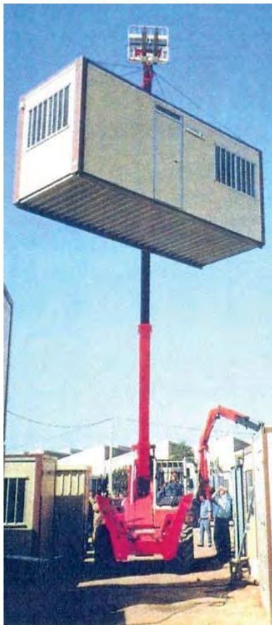
Figura A.99 – DIFERENTES SOLUCIONES EN PLANTA DE CASETAS PROVISIONALES DE OBRA TIPO CONTENEDOR PARA SU FÁCIL TRANSPORTACIÓN, ENSAMBLADO Y APILADO - Fuente: Fotografía de Empresa MANITOU, Chantiers de Bâtiment, Préparation et Suivi, Bernard VUILLEME et Henri Richaud, Edit. Nathan Technique, Ficha-20; p. 91 – Cantonnements-Réseaux, 2002
