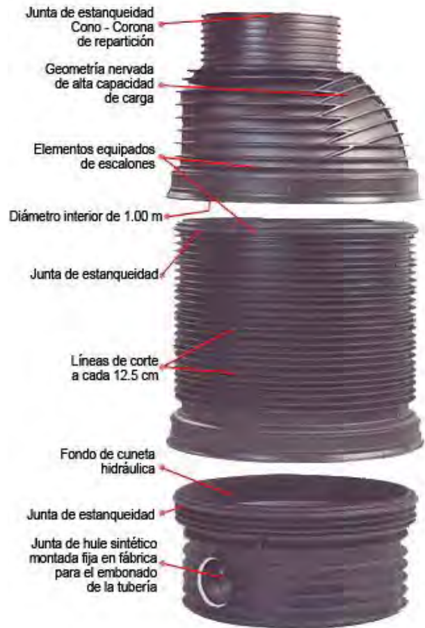
Figura B.541 – PARTES CONSTITUTIVAS DE UN POZO DE VISITA DE PLÁSTICO COMPUESTAS PRINCIPALMENTE POR UNA BASE O ELEMENTO DE FONDO, EL ANILLO QUE DA LA ALTURA DESEADA, EL CONO Y EL REMATE. EL ESTRIADO O ANILLADO EXTERIOR PERMITE ASEGURAR SU ADHERENCIA CON EL SUELO ENVOLVENTE.
