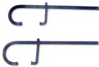
Figura A.175 – SARGENTOS PARA SOPORTE DE CIMBRA DE COSTADOS, DE CADENAS, CASTILLOS Y TRABES
