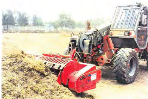
Figura B.38a – PROCESO DE RETIRO DE TIERRA POR CRIBADO Y ROTACIÓN DE CUCHARÓN para posterior triturado de la capa vegetal producto de despalme.
