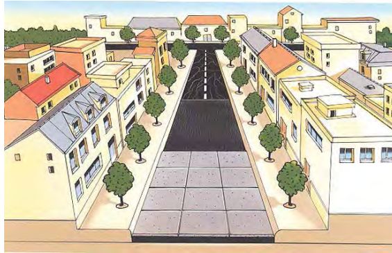
Figura B.781 – SOBRECAPAS DE CONCRETO ULTRADELGADO utilizadas en vialidades de vivienda. Se puede apreciar en la figura el proceso de colocación de este tipo de obra con la secuencia del fondo hacia el frente.
