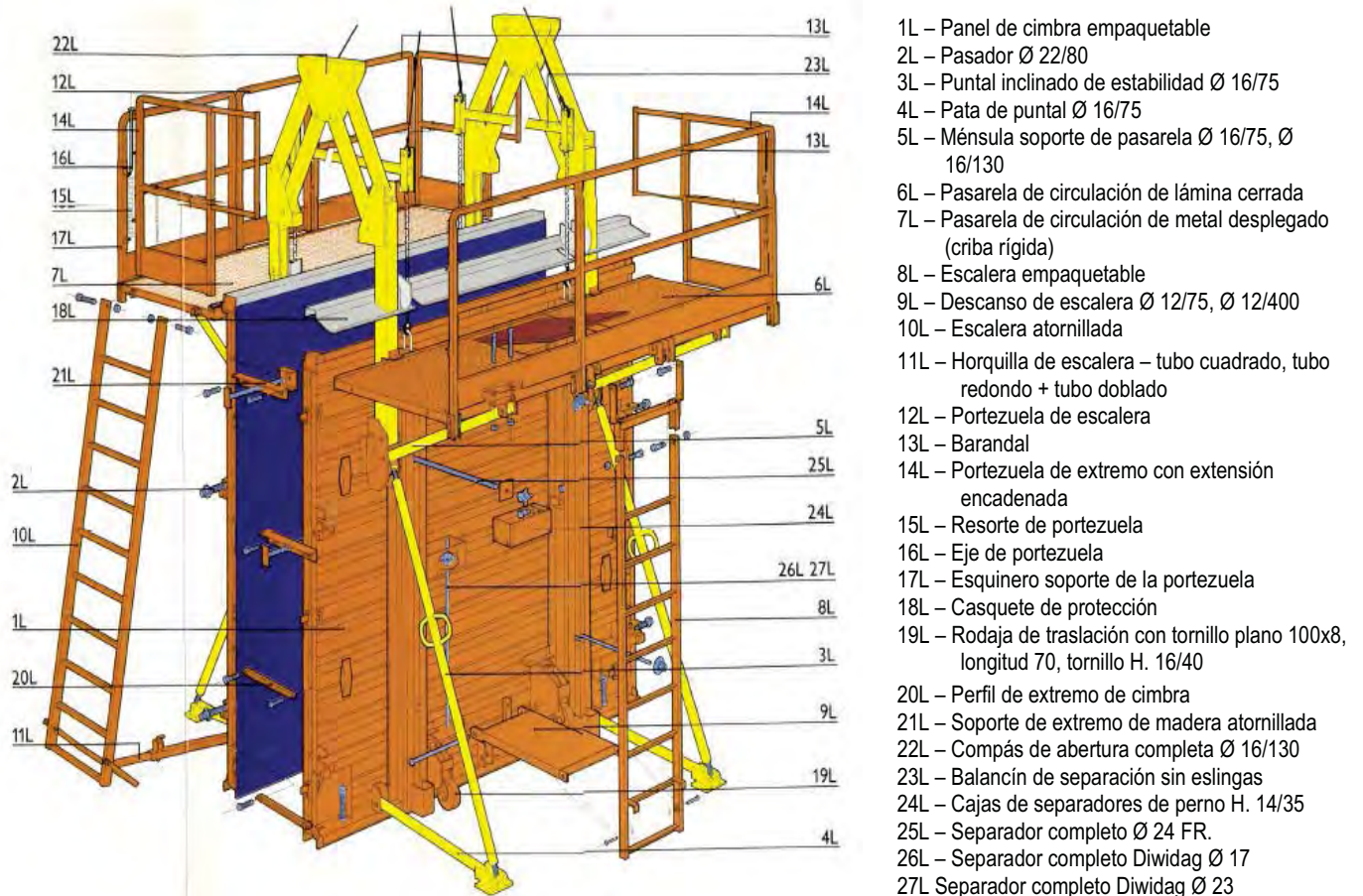
Figura B.120 – EMPLEO DE CIMBRAS-HERRAMIENTA EN MUROS - Fuente: OUTINORD
