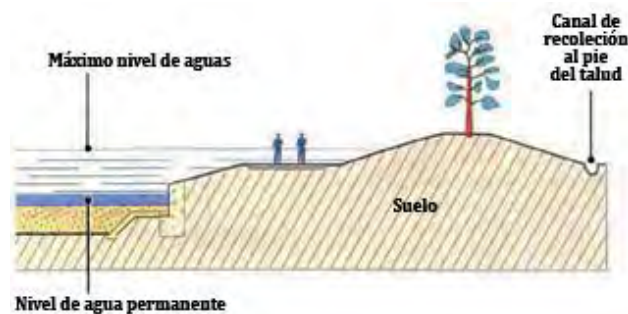
Figura C.33 – ESQUEMA DE PRINCIPIO Y EJEMPLOS DE ESTANQUES O LAGOS ARTIFICIALES DE REGULACIÓN que asegura una decantación primaria de materias en suspensión - Fuente: Revista Le Moniteur, Jun. 1996, dossier technique; p. 69
