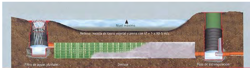
Figura C.2 – RETENCIÓN Y DRENAJE DE AGUA PLUVIAL
