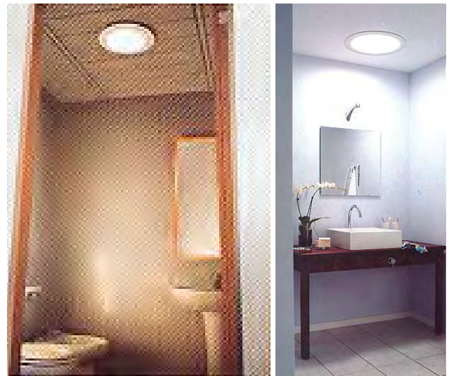
Figura B.462 – ILUMINACIÓN CENITAL INDIRECTA CON OPCIÓN DE VENTILACIÓN MECÁNICA
