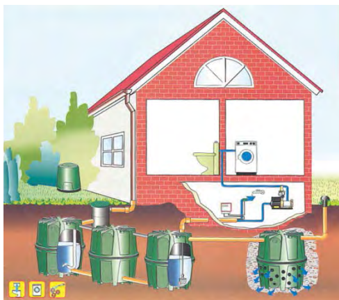
Figura B.556e – EJEMPLO DE APLICACIONES EN VIVIENDA DE MÓDULOS DE ALMACENAMIENTO Y MANEJO DEL AGUA DE LLUVIA en los proyectos de sistemas alternativos de aprovechamiento
