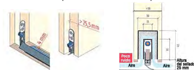
Figura B.421 - SELLADO DE PUERTAS EN BAÑOS CON EXTRACTOR permite un paso de aire de 200 m 3 /hora con una absorción de ruido de 28 dB - Fuente: Catálogo de productos, empresa PLANET
