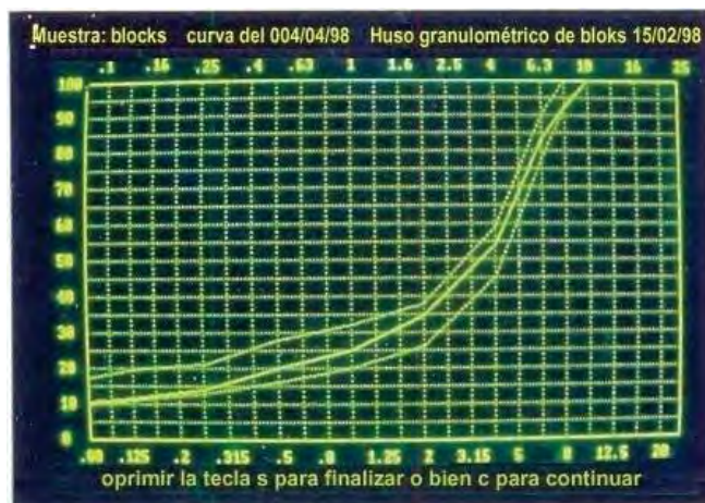
FIGURA A.287 – HUSO GRANULOMÉTRICO DE REFERENCIA Y CURVA que cumple el rango de aceptación de un producto de concreto manufacturado analizado en computadora.
