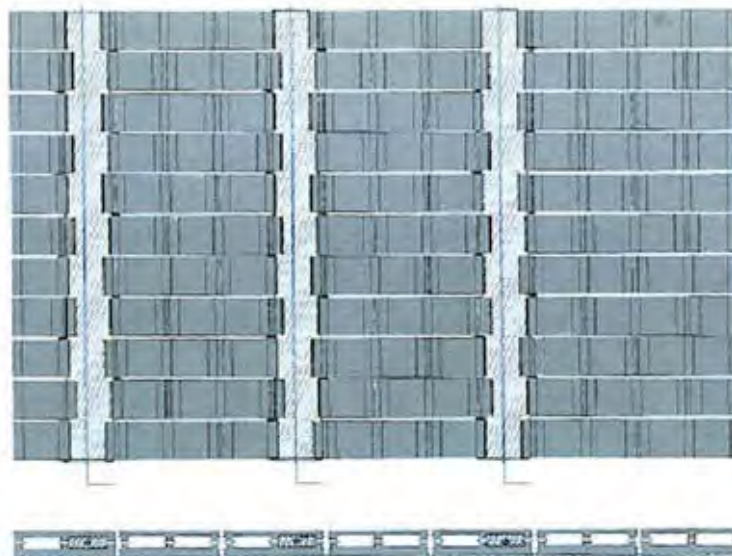
Figura B.110 - LLENADO DE CASTILLOS CON MORTERO DE RELLENO EN MUROS Mampostería hueca con alveolos perimetralmente sellados con el mortero de asiento.
