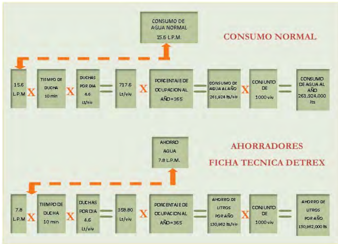
Figura C.40 – DIAGRAMA ANALÍTICO DE REDUCCIÓN DE CONSUMO DE AGUA empleando ahorradores marca DETREX para proyectos de vivienda de interés social, elaborado por el Arq. Alberto NIEVES DEL TORO
