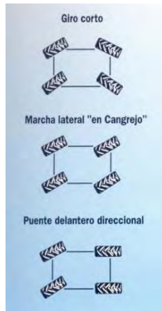
Figura A.133 - Modos de giro de los equipos multifuncionales
