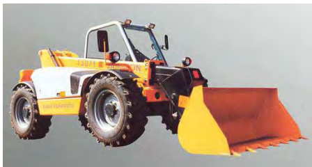
4.- ELEVADORTELESCÓPICA – Marca FDI-SAMBRON (Francia) portando un cucharón para terracerías con el brazo retraído.
