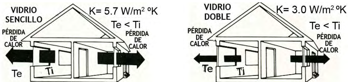
Figura B.308 – Entre menor sea el valor de K menores pérdidas de calor se tendrán Ref. Revista Le Moniteur, octubre 1984 – Michel CHAUMAC
