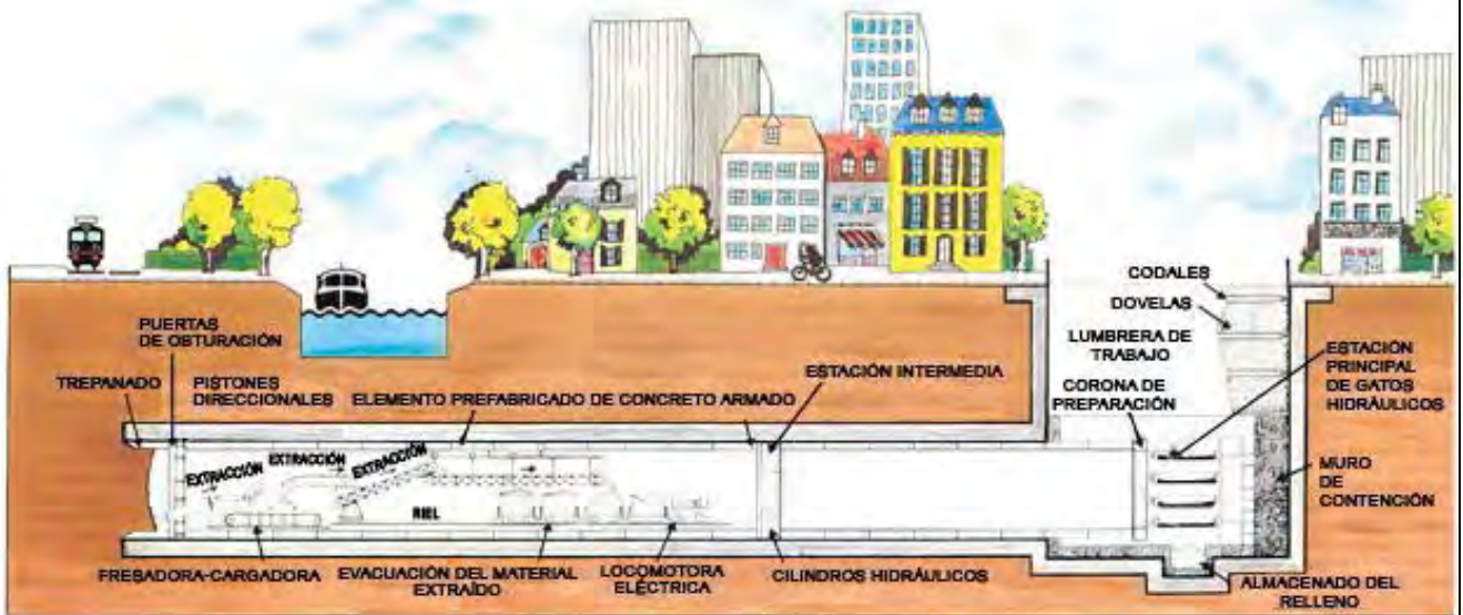
Figura B.595 – MICROTUNELAJE CON HINCADO HORIZONTAL DE TUBOS DE CONCRETO ENSAMBLADOS
