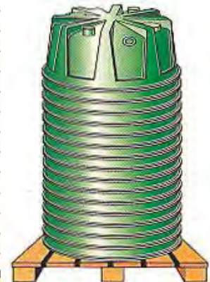
Figura B.556f – MÓDULO DESARMABLE en 2 sub-módulos para permitir su suministro a través de viviendas habitadas
