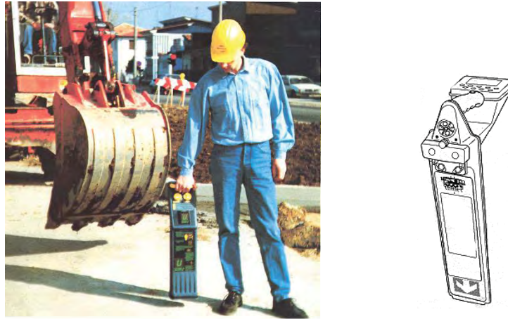
Figura A.144 – LOCALIZADOR DE TUBERÍAS – Indica dirección y profundidad de canalizaciones eléctricas, telefónicas, etc. y tubería de gas, agua potable, drenaje, etc.
