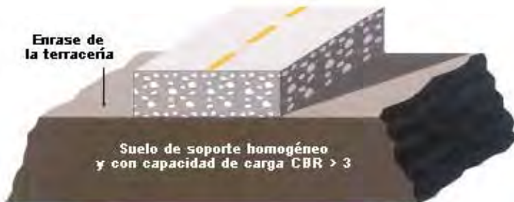
Figura B.630d – CASO DE UN SUELO HOMOGÉNEO Y CON SUFICIENTE CAPACIDAD DE CARGA
