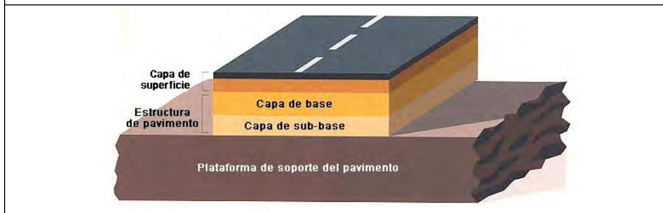
Figura B.623b – ESTRUCTURA DE UN PAVIMENTO FLEXIBLE
