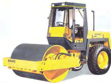
I - EQUIPO BÁSICO para compactación de terracería granular
