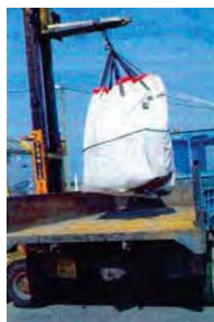
Fácil de vaciarse al poderse desfondar al tirar un cordel a distancia. Al desfondarse la bolsa debe estar apoyada sobre su soporte (suelo, plataforma de camión, etc.) para no dejar caer el material con el riesgo de provocar un accidente y de dispersar polvo.
