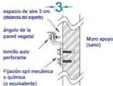
FIJACIÓN DE LAS CÉLULAS METÁLICAS EN EL MURO APOYO
