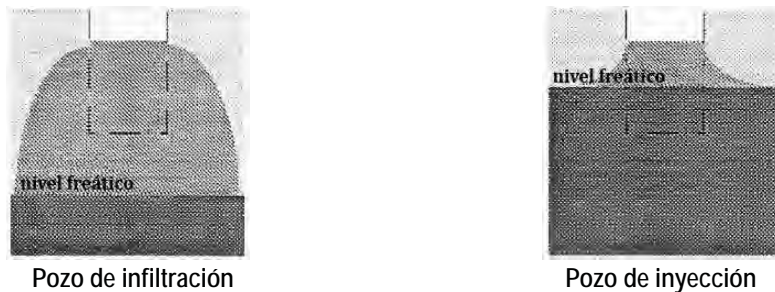
Figura C.6 – POZOS DE INFILTRACION O DE INYECCION
