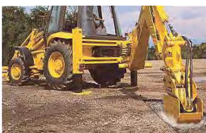
Compactador de zanjas y taludes principalmente (placa vibratoria)
