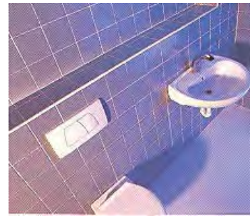
Figura B.255 – INSTALACIÓN DE LA PLOMERÍA EN MÓDULOS (un módulo por cada mueble) conectados y complementados entre sí y con las tuberías de alimentación y descarga general. Con el empleo de ductos técnicos, muretes técnicos y banquetas técnicas se reduce el trabajo a pocas operaciones de montaje.
