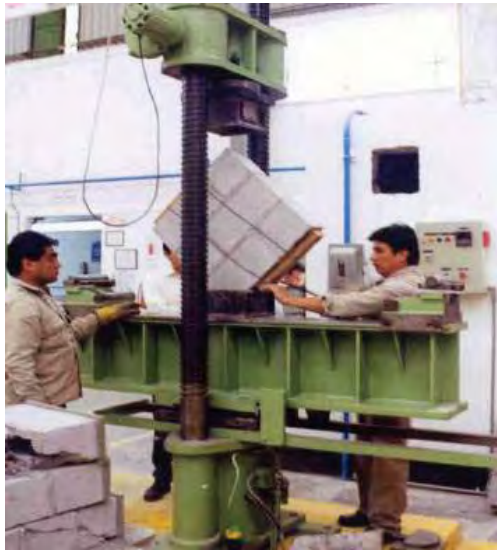
Fig. A.21c - Ensayo de muretes de block de concreto - Fotografía tomada en el Instituto de Ingeniería UNAM
