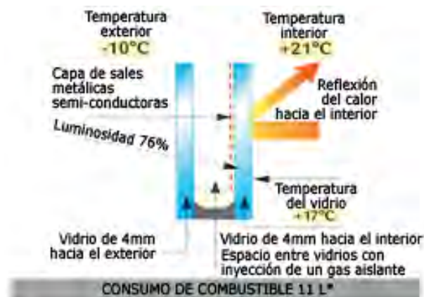
Figura B.323 – VIDRIO CON DOBLE VIDRIO CON SALES METÁLICAS PARA BAJA EMISIVIDAD
