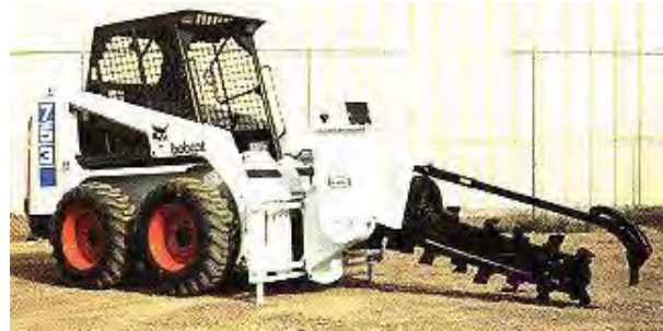
Bobcat con zanjadora
