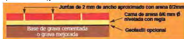
Figura B.714 – ESTRUCTURA BÁSICA DE PAVIMENTO DE ADOQUINES DE BARRO Fuente: Catálogo de productos empresa: BRIQUE DE VAUGIRARD
