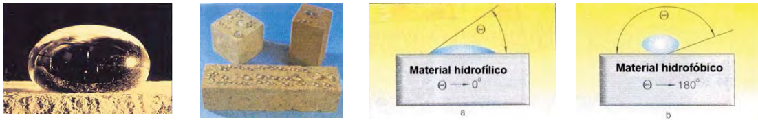
Figura B.450 – EFECTO PERLANTE DADO POR LAS CARACTERÍSTICAS HIDROFÓBICAS DEL HIDROFUGANTE
