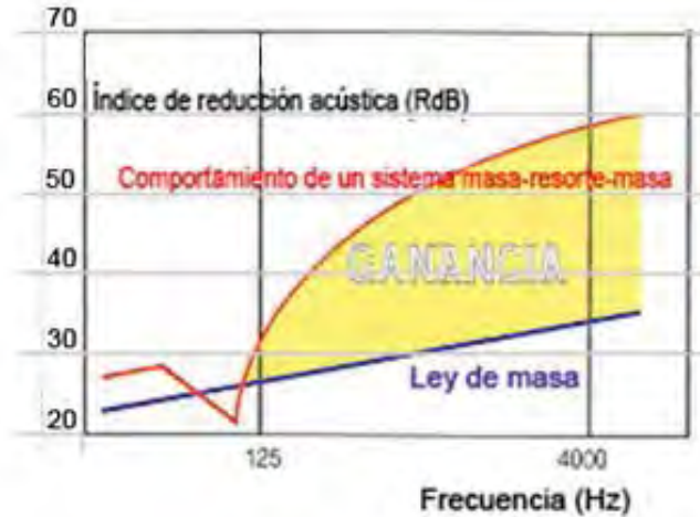
Figura B.206 – Ejemplo: Es suficiente una pared de 50 \text{ kg/m}^2 para obtener un aislamiento acústico R=50 \text{ dB(A)} .
