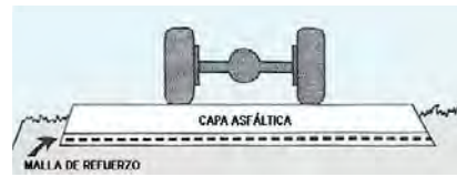
Figura B.628a – DEGRADACIÓN TÍPICA DE LAS CARPETAS DE ASFALTO TRADICIONALES
