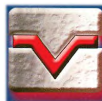
Figura B.27b – DETALLE DE MACHIMBRE SELLADO EN FORMA DE DIEDRO
