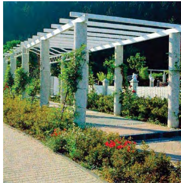
Figura C.116 – PERGOLAS que permiten el tamizado de la luz solar por medio de vigas espaciadas que eventualmente sirven de soporte y guía a plantas trepadoras.
