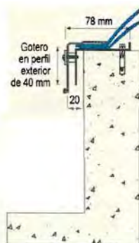
Domo sobre brocal de concreto
