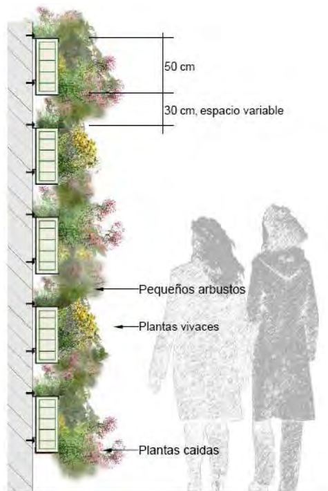
Figura C.120c - MURO CON VEGETALIZACIÓN EXTENSIVA Fuente: Presentación digitalizada, empresa CANEVAFLOR, Francia
