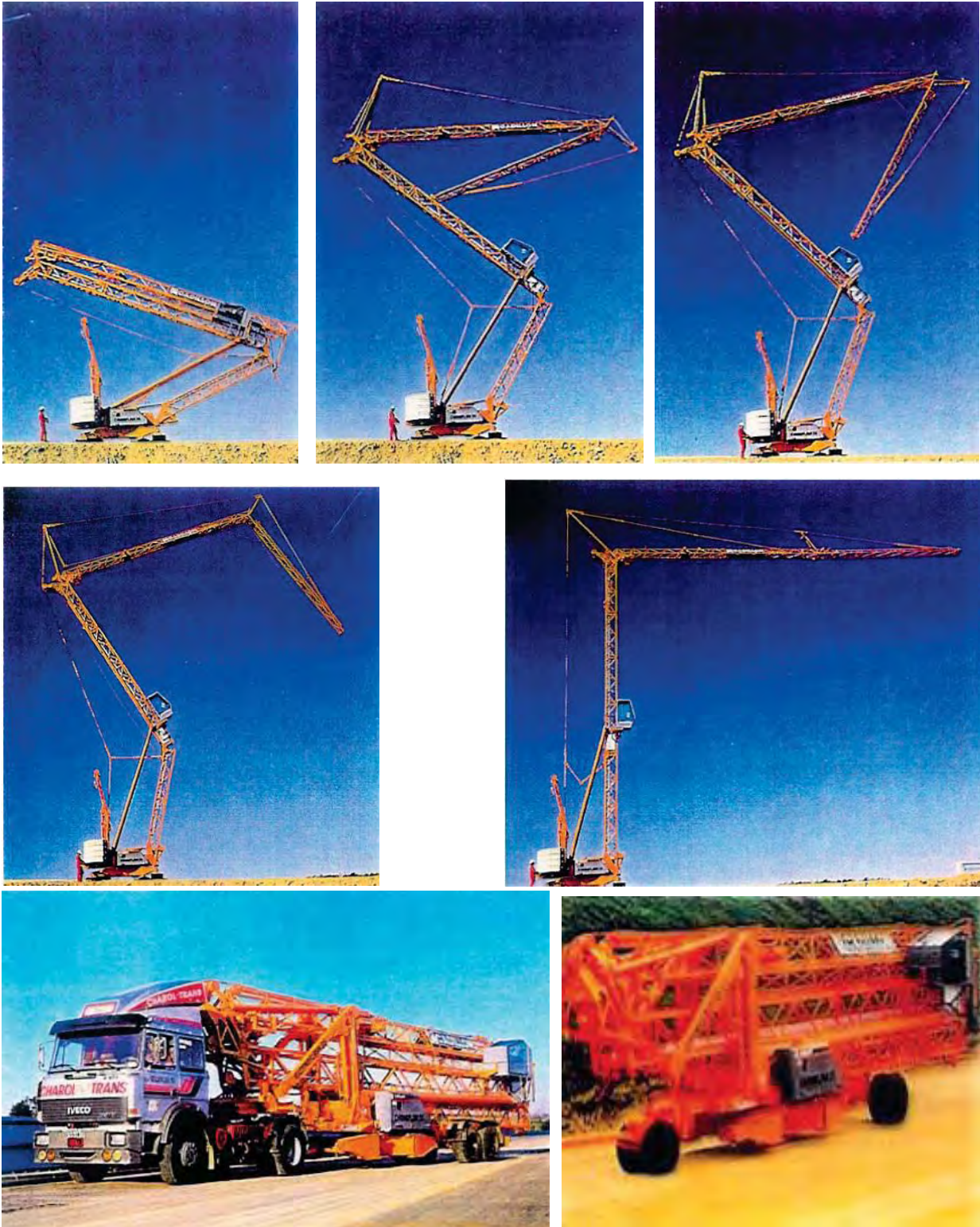
Figura A.120a – Como variantes se han desarrollado, desde hace ya varios años, las grúas torre auto-desplegables las cuales requieren menos tiempo para su instalación y retiro Fotografías tomadas del catálogo de grúas BPR Cadillon
