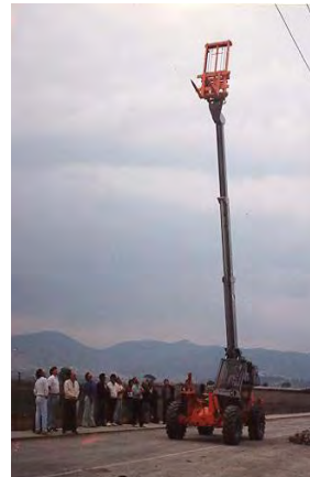
7.- ELEVADORA TELESCÓPICA con mástil sobre-elevador retraído v extendido.
