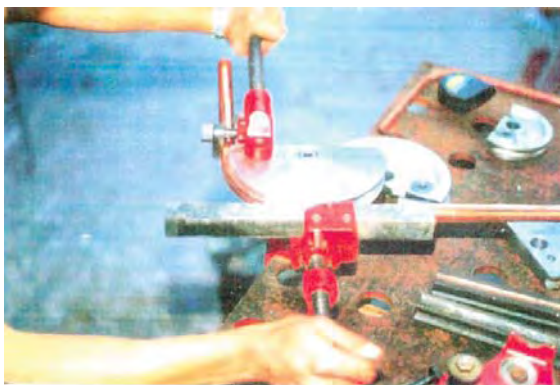
Figura A.201 – PREFABRICACIÓN DE TUBERÍA DE COBRE para instalación hidráulica con sencillas y económicas máquinas-herramienta para doblar, abocinar y conectar tubos en “T” ahorrándose con esto piezas de conexión y uniones soldadas.
