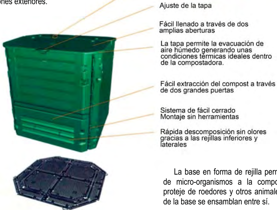
Figura C.142 – COMPOSTADORA DE PLÁSTICO – Fuente: Catálogo de productos, empresa THERMO-KING; p. 22
