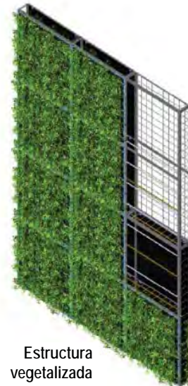
Figura C.119b – PLANTAS SEMBRADAS SOBRE SOPORTE TEXTIL FIJADO A ESTRUCTURAS METÁLICAS
