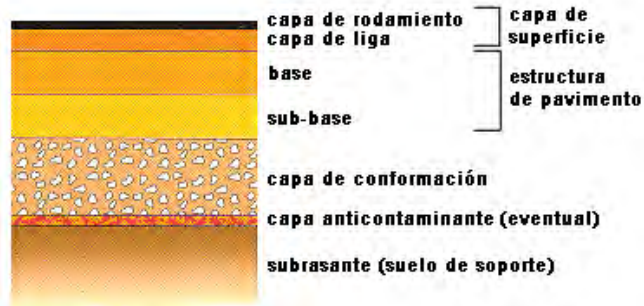
Figura B.617 - CAPAS QUE COMPONEN LA CONSTITUCIÓN DEL ESPESOR DE UN PAVIMENTO DE REFERENCIA
