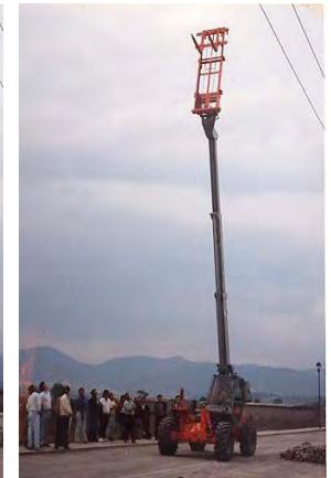
7.- ELEVADORA TELESCÓPICA con mástil sobre-elevador retraído v extendido.
