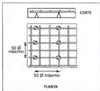
Figura B.76 – CALZAS INDIVIDUALES EN EMPARRILLADO SUPERIOR DE LOSA
