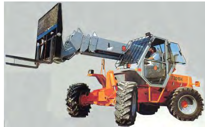
5.- ELEVADORA TELESCÓPICA – Marca FDI-SAMBRON (Francia) autoestable con brazo retraído.
