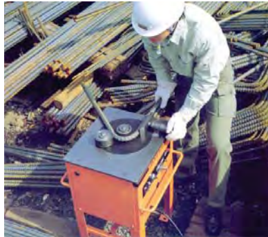
Figura A.195 – DOBLADORA DE VARILLA FIJA
