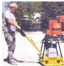
Figura A.192b– PLACA VIBRATORIA CON SUELA DE POLIURETANO
