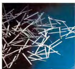
Figura B.64 – FIBRAS METÁLICAS AMORFAS para refuerzo de concretos y morteros. Por su aleación con cromo tienen una alta resistencia a la corrosión. Su estado amorfo les confiere, además de flexibilidad, una alta resistencia mecánica.
