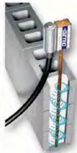
EFECTO DE UN VIBRADOR EXTERNO ACOPLADO A LA VARILLA EN EL CONCRETO DE UN CASTILLO AHOGADO
