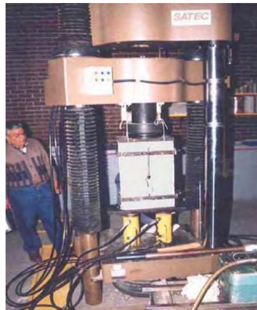
Fig. A.21d - Ensayo de pilas de block de concreto - Fotografía tomada en el Instituto de Ingeniería UNAM
