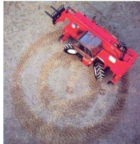
Figura A.134 – RADIOS DE GIRO REDUCIDOS POR LA DIRECCIÓN EN LAS 4 RUEDAS
