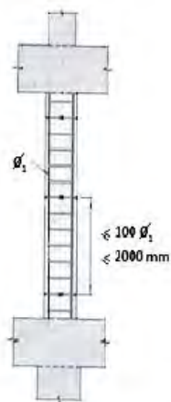
Figura B.82 – DISPOSICIÓN DE SEPARADORES EN COLUMNAS
