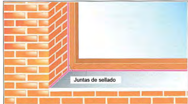
Figura B.434b – JUNTA ENTRE VENTANA Y MURO Ref. Catálogo Técnico – Selladores WACKER
