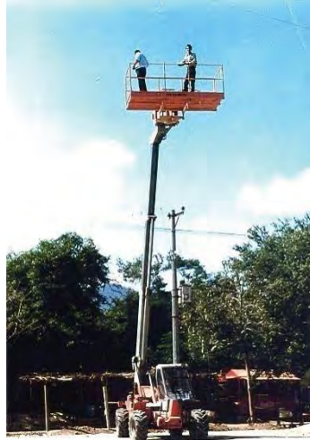
2.- ELEVADORTELESCÓPICA – Marca FDI-SAMBRON (Francia) autoestable portando canastilla
