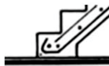
Figura B.474a - DETALLE DE APOYO DIRECTO DE RAMPA DE ESCALERA SOBRE LOSA DE PISO (Sin acero de espera) Fuente: Les désordres dans les ouvrages de bâtiment , éditions WEKA, 1994, tomo 5, parte 10, cap. 7.4.4.6; p.28
