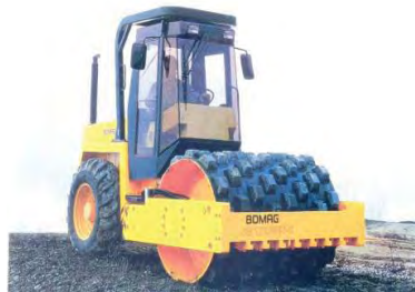
II.- Con conchas tipo pata de cabra sobrepuestas para compactación de arcilla
