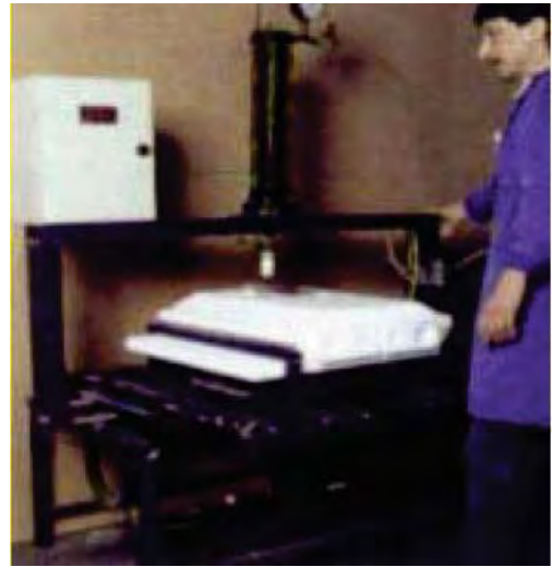
Fig. A.21b - Ensayo de bovedilla de poliestireno expandido Imagen tomada del Catálogo de PPB SARET
