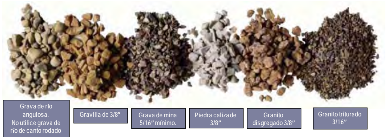
Figura B.643 – DIFERENTES COLORES Y TEXTURAS (tamaños) de gravas para clavado de pavimentos - Fuente: Voiries et Aménagements Urbains en Béton Tome-2, Mise en Oeuvre, T-51 CIMBÉTON-1996
