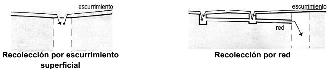
Figura C.4 – MODOS DE RECEPCIÓN DEL AGUA A LOS POZOS
