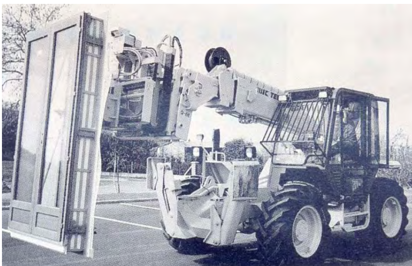
Figura A.275 – AUTÓMATA HIDRÁULICO FIJ, orientable en todas direcciones, instalado en la punta del brazo telescópico de una elevadora multifunciones 530-110 JCB para la colocación y fijación de ventanas y cancelas desde el exterior (Ventajas: 10% a 12% de ahorro en costo de colocación y una colocación en la quinta parte de tiempo).
