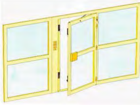
Figura B.381 – PUERTA DE ACCESO A EDIFICIO DE VIVIENDAS CON PERFILES DE ACERO Ref. Catálogo MANNESMANN (Francia)
