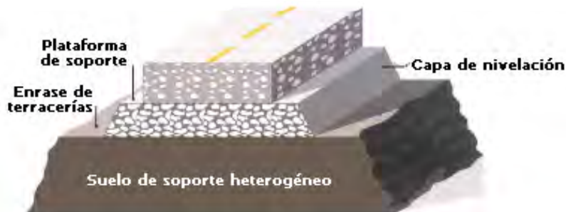
Figura B.630c – CASO DE UN SUELO HETEROGÉNEO Y CON CAPACIDAD SUFICIENTE DE CARGA
