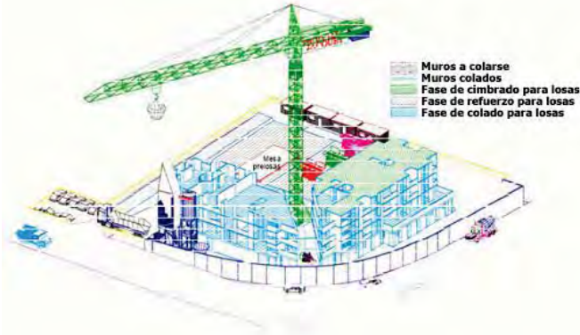
Figura A.247a – RADIO DE ACCIÓN DE LA GRÚA cubriendo toda el área de trabajo
