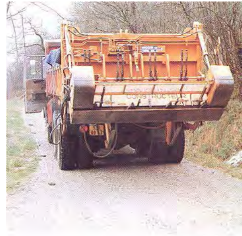
Figura B.621 – PARA ENCARPETADOS DE POCO VOLUMEN (caso de proyectos de vivienda) como vialidades y áreas de estacionamiento, el uso de finishers montadas sobre camiones de material bituminoso, son una opción eficiente y rentable en obras pequeñas y medianas, por su rapidez de ejecución.
