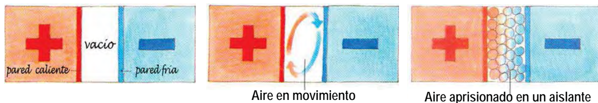
Figura C.58 – TRANSMISIÓN DEL CALOR POR UNA PARED
