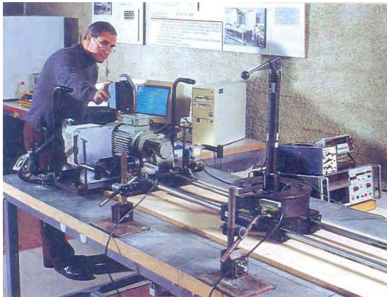
Fig. A.21g - Prueba de frotación sobre losetas para evaluar sus características antideslizantes - Imagen tomada del Reporte de actividades — CERIB 1995 - p.14
