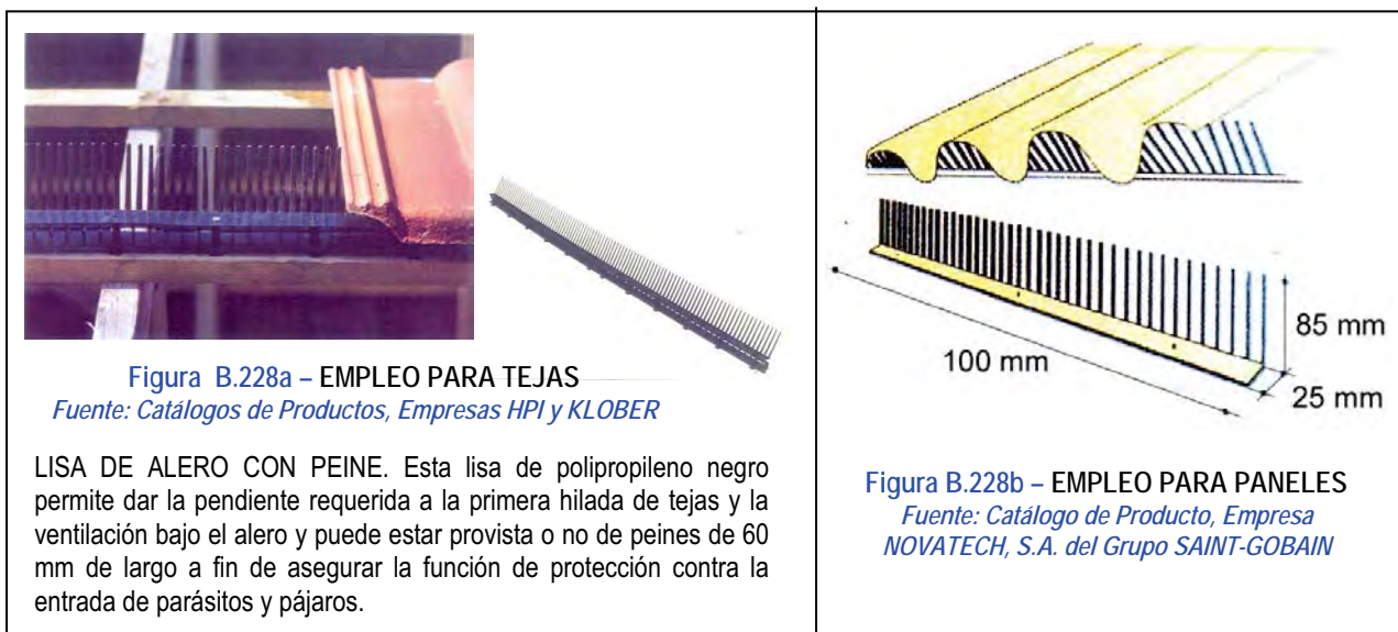
Figura B.228 - PEINE EN ALEROS que permite la ventilación de la cubierta en su cara inferior impidiendo el acceso y anidado de pequeños animales
