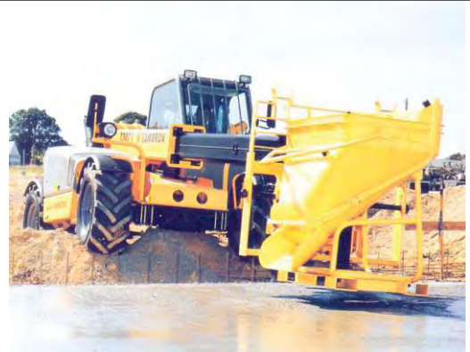
EMPLEO DE TOLVA DE CONCRETO CON DOS OPCIONES DE VACIADO: FRONTAL Y LATERAL
