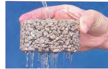
Figura B.756 FLUJO DE AGUA A TRAVÉS DE UN CONCRETO DRENANTE Fuente: Pervious concrete pavements. Paul D. TENNIS et Al.; P.C.A. y NRMCA, 2004; portada
