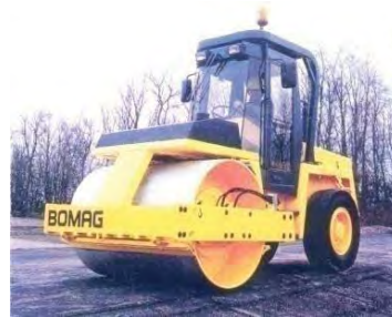
III.- Con rodillo liso, depósito de agua y llantas lisas para trabajos de pavimentación
