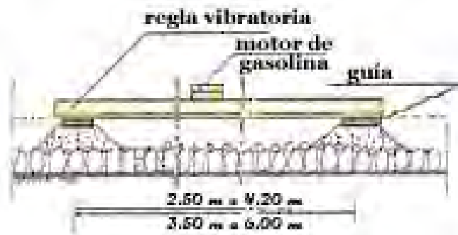
Figura B.87 – NIVELADO DE LA SUPERFICIE DE LOSA DE CONCRETO
