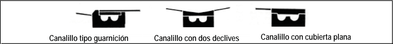
Figura B.517 - EJEMPLOS DE SECCIONES DE CANALILLOS TÉCNICOS – Fuente: La Pratique des V.R.D. dans les Opérations d'Habitat à Faible ou Moyenne Densité; Jean-Eudes ROULLER, Georges Mercadal et Pierre Richard; Edit. Le Moniteur, 1982 – p. 175
