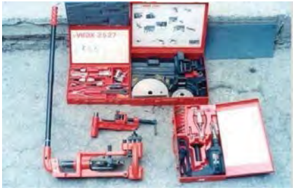
Figura B.244a – JUEGO DE MÁQUINAS-HERRAMIENTAS para abocinado, doblado y unión perpendicular (en “Te”) de tubería de cobre
