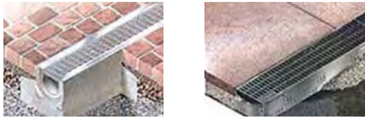
Figura B.560 – LOS CANALILLOS EN MUCHOS CASOS SE FABRICAN CON CONCRETO POLIMÉRICO DE ALTA RESISTENCIA con objeto de reducir volumen y peso de material Fuente: Catálogo de productos empresa BIRCO
