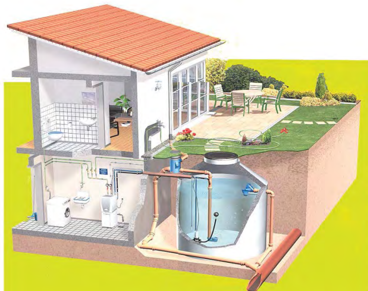
Figura C.24 – CISTERNA VERTICAL DE ALMACENAMIENTO DE AGUA PLUVIAL E INSTALACIÓN DE ALIMENTACIÓN A MUEBLES HIDROSANITARIOS
