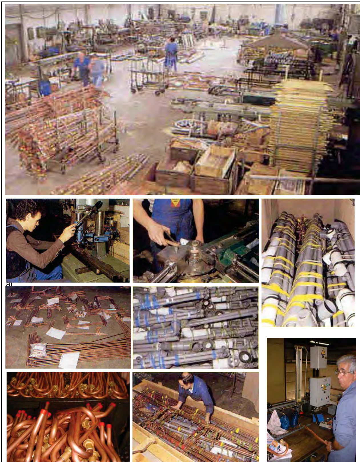
Figura B.243 – PREFABRICACIÓN DE TUBERÍA EN KITS despiezados en tramos prearmados para ser transportados en cajas del taller de plomería al frente de la obra.
