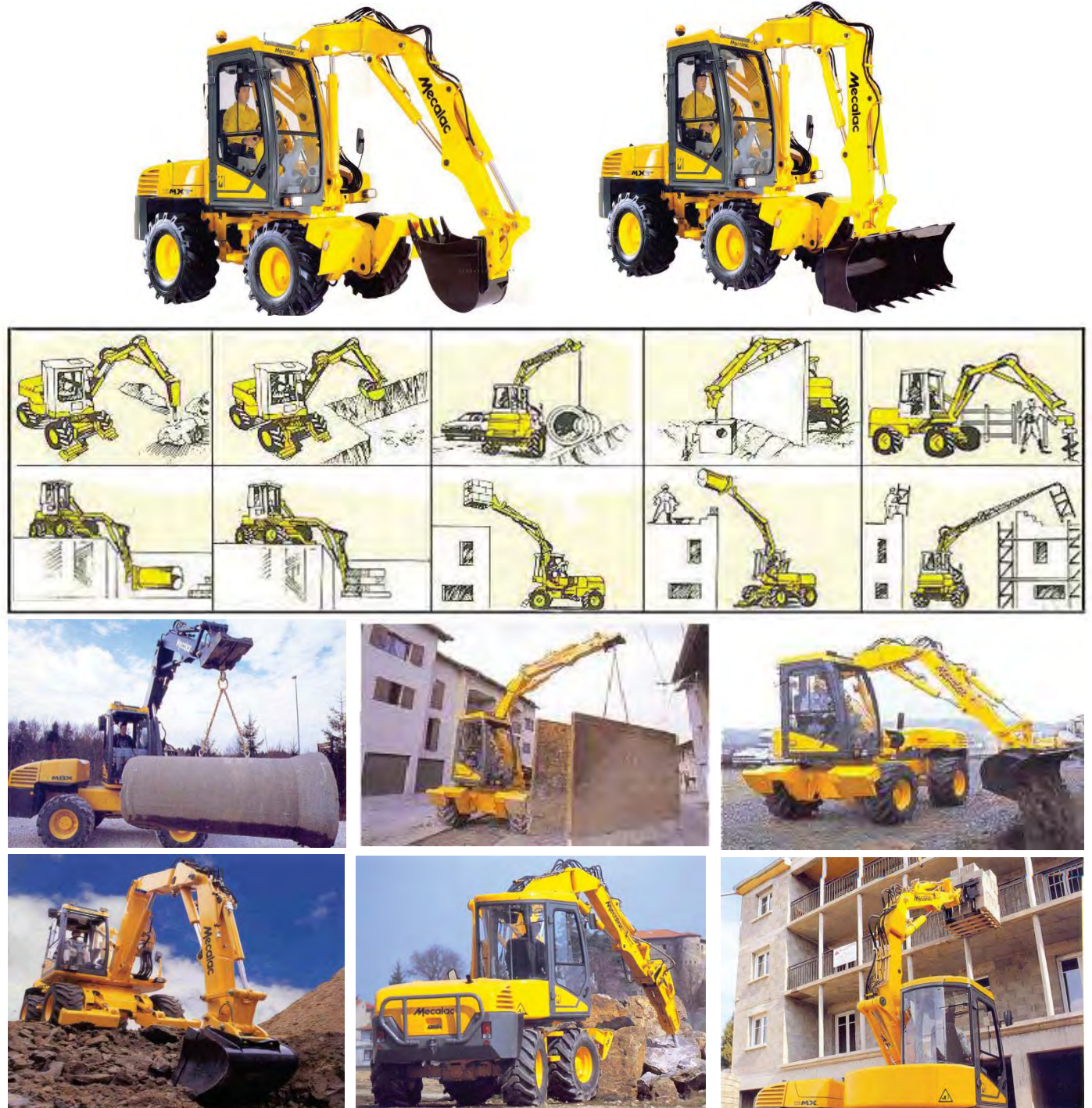
Figura A.116a – CARGADORA, RETRO-EXCAVADORA Y MONTACARGAS MULTIFUNCIONES DE ROTACIÓN TOTAL Mecanización polivalente para su máxima rentabilización lograda por el uso de equipo de configuraciones diferentes y por gamas de accesorios de acoplamiento rápido.
