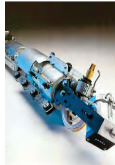
Figura A.277c – Detalle del robot para recorrido por dentro de tuberías
