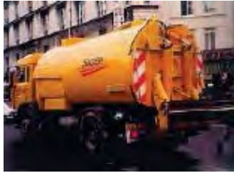
Figura B.765a – ASPIRADORA utilizada para la limpieza de las superficies rugosas
