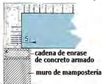
Figura B.191c – Apoyo de 5 cm sobre muro de mampostería con o sin apuntalamiento
