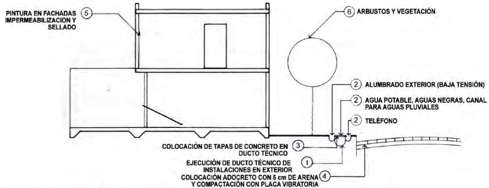
Figura A.208 – ETAPAS SECUENCIALES DE CONSTRUCCIÓN PARA EL CASO DE UNA VIVIENDA DE 65 M 2 EN DOS NIVELES
