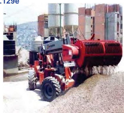
Cucharón cribador rotatorio para cribado de material – Con este accesorio adaptable por acoplamiento rápido podemos sustituir el tedioso trabajo de cribado de arena para morteros manual por un rápido y controlado tamizado, el cual puede efectuarse sólo durante unos minutos en la mañana para poder premezclar y utilizar el mortero necesario para toda la jornada - Fuente: Catálogo de Productos, Empresa ROTAR CLEANER
