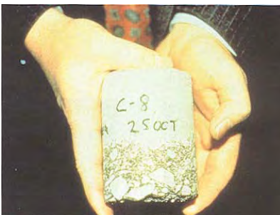
Figura B.785 – CORAZÓN EXTRAÍDO DE UN PAVIMENTO ASFÁLTICO CON SOBRECAPA DE CONCRETO para comprobar la correcta adherencia en su interfase.
