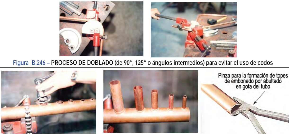
Figura B.247 – PROCESO DE SACABOCADO Y DE UNIÓN PERPENDICULAR para evitar el empleo de conexiones en “Te” y de reducciones – Ref. Máquinas-Herramienta marca VIRAX
