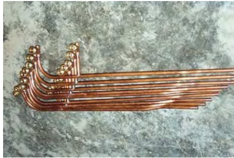
Figura B.248 – ARMADO Y AGRUPAMIENTO DE RAMALEOS HABILITADOS PARA SU COLOCACIÓN EN OBRA Fotografías tomadas en taller de plomería, Empresa PREINSA y Empresa THOMPSON
