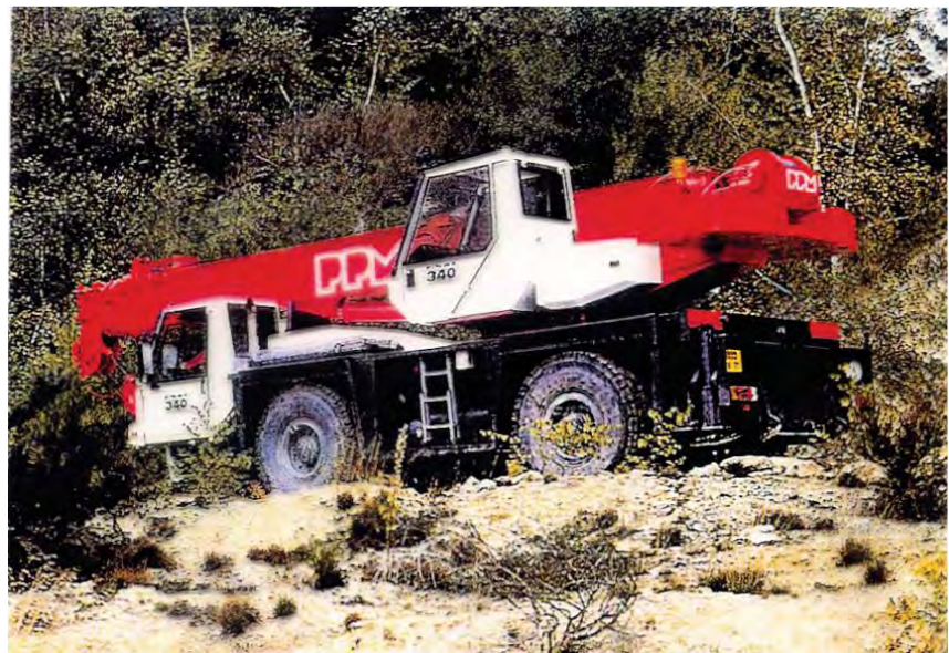
Figura A.118 – GRÚAS MÓVILES - Las grúas móviles todo terreno con cabina y pluma giratoria son de gran utilidad para unidades habitacionales con edificios altos o de difícil alcance y tanques elevados de agua.
