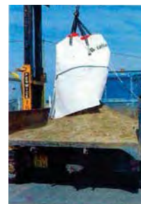
Fácil de vaciarse al poderse desfondar al tirar un cordel a distancia. Al desfondarse la bolsa debe estar apoyada sobre su soporte (suelo, plataforma de camión, etc.) para no dejar caer el material con el riesgo de provocar un accidente y de dispersar polvo.
