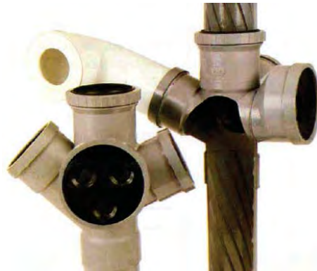
Figura B.282 – PROPUESTA DE ELIMINACIÓN DE TUBERÍA DE DOBLE VENTILACIÓN POR MEDIO DE BAJADAS CON VENAS HELICOIDALES EN SU PARED INTERIOR
