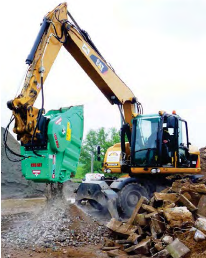
Figura B.38d – CUCHARÓN TRITURADOR - Tritura material que va de 20 mm a 120 mm de diámetro o longitud. Se elimina el uso de un equipo especializado para reciclar - Fuente: Empresa MONTABERT
