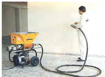
Figura B.460c - LANZADORA DE APLANADOS DE YESO sin desperdicio de material Fuente: Catálogo de Productos, Empresa WAGNER
