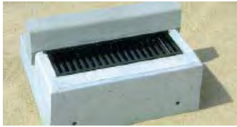
Figura B.578a – BOCA DE TORMENTA – Aseguran la colecta de aguas pluviales. Su conexión con la tubería de evacuación se logra por medio de juntas flexibles de estanqueidad para presiones de hasta 0.04 MPa (.40 kg/cm 2 )
