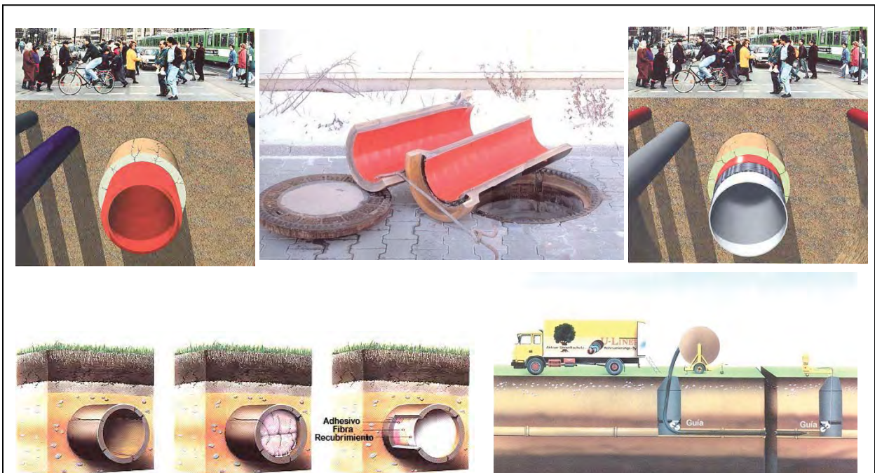
Figura B.598-A - REHABILITACIÓN Y REFORZAMIENTO DE PAREDES INTERIORES EN TUBERÍA EXISTENTE Fuente: Catálogos de empresa PHOENIX SERVICES
