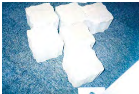
Figura B.682 – ADOQUINES CON SEPARADORES INCLUIDOS para permitir dar un mayor ancho a las juntas sin movimiento de las piezas y con biselados perimetrales para evitar despostillados.
