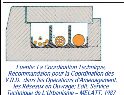
Figura B.514 - EJEMPLO DE BANQUETAS TÉCNICAS REGISTRABLES PARA ALOJAR DIVERSAS INSTALACIONES DE TODO TIPO (Electricidad, agua potable, aguas pluviales, telefonía, gas, etc.).
