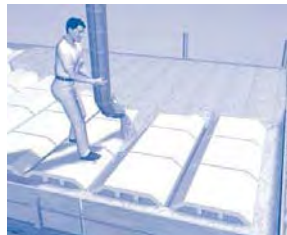
Figura B.155 – VACIADO DEL CONCRETO SOBRE LAS VIGUETAS (No sobre las bovedillas) Ref. Manual de aligeramiento de estructuras ANAPE (Asociación Nacional de Poliestireno Expandido)- España - p. 90 Art. 4.2.2.3.63
