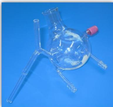
Figura 10 Simulador farmacocinético. Compartimento A, vástago del sistema de eliminación y sistema de toma de muestra tipo Vacutainer.
