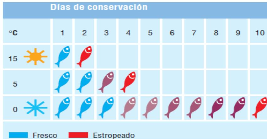
Figura 2.- Ejemplo del efecto de la temperatura sobre el deterioro de un pescado magro de aguas tibias (FAO. Documento Técnico de pesca 331. Roma, 1993).
