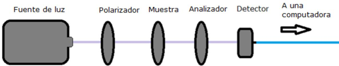
Fig. 4.1.2. Diagrama simple del arreglo experimental general P-A. Con esta configuración (P-A paralelo y P-A perpendicular respectivamente), se mide la intensidad.
