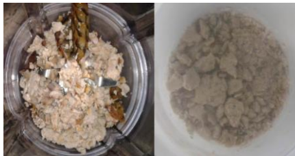
Imagen 4.4. Muestras de filete de pescado antes y después del proceso de liofilización, respectivamente
