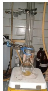
Imagen 4.7. Material montado para realizar la derivatización de los ácidos grasos de mojarra-tilapia
