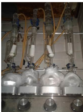
Imagen 4.6. Extracción Soxhlet empleando éter de petróleo, p.e. 30 a 60°C, de muestras de mojarra-tilapia
