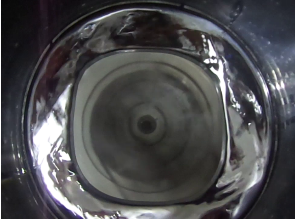
Fig. 3.6: Patrón de flujo obtenido experimentalmente con el arreglo de cuatro imanes. En este caso, el polígono de cuatro lados no rota alrededor del eje de simetría.
