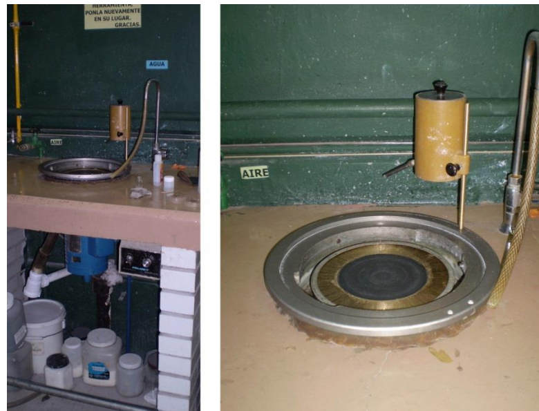
Figura 4.6. Pulidora del Laboratorio de Cristalofísica y Materiales Naturales del IFUNAM.
