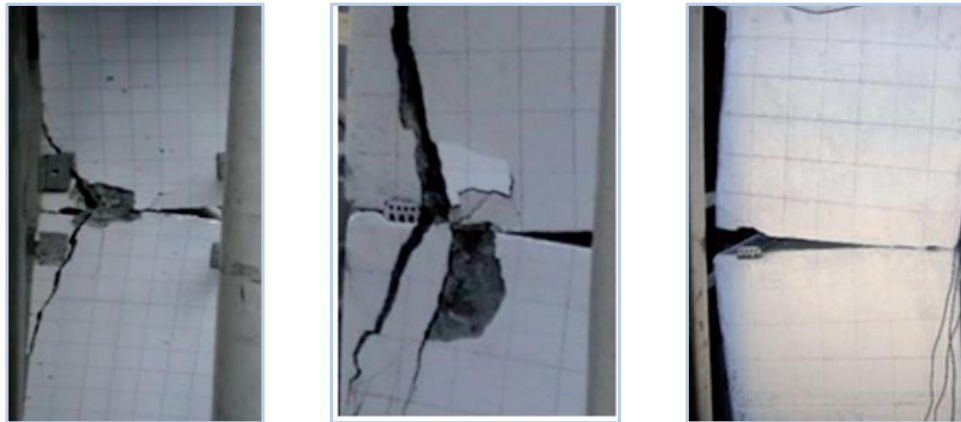
a) b) c) Figura 16. Fallas de las juntas (Peña et al., 2012) para excentricidades de: a) 3 cm; b) 6 cm; c) 9 cm
