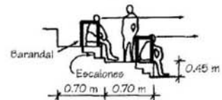
Las escaleras de acceso a las gradas deberán contar con un barandil que no obstruya el paso hacia las mismas.
