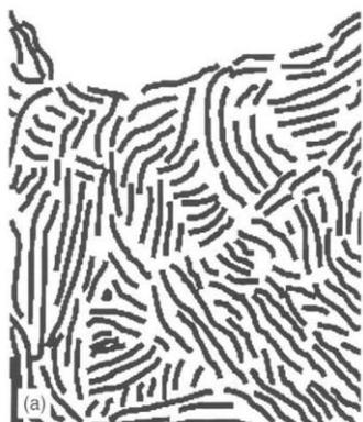
Figura 1.2. (a) Ilustración del modelo de Norit que señala una estructura de los carbonos activados hecha de capas de átomos de carbono.
