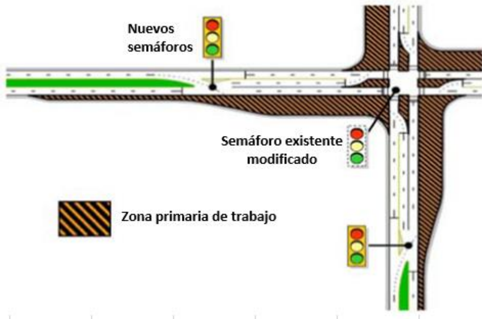
Figura 2-11 Zonas de trabajo principales en la construcción de una PFI Fuente: Parsons, 2009
