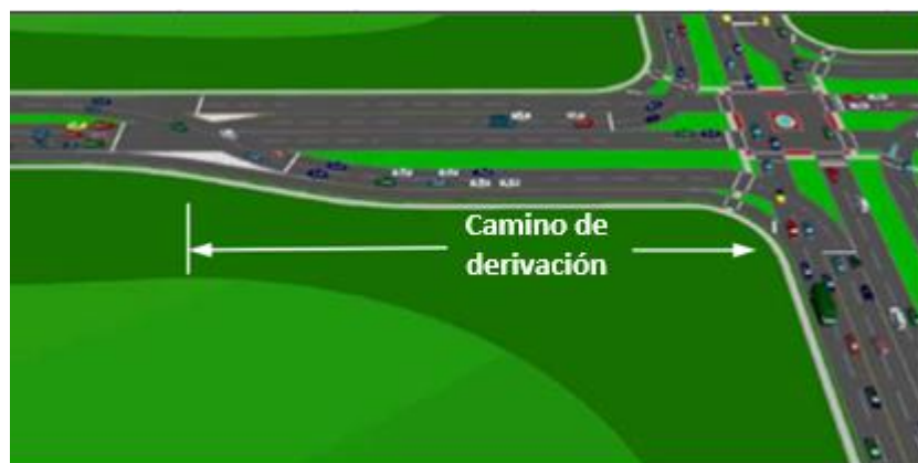
Figura 2-7 Detalle de una intersección de flujo paralelo
