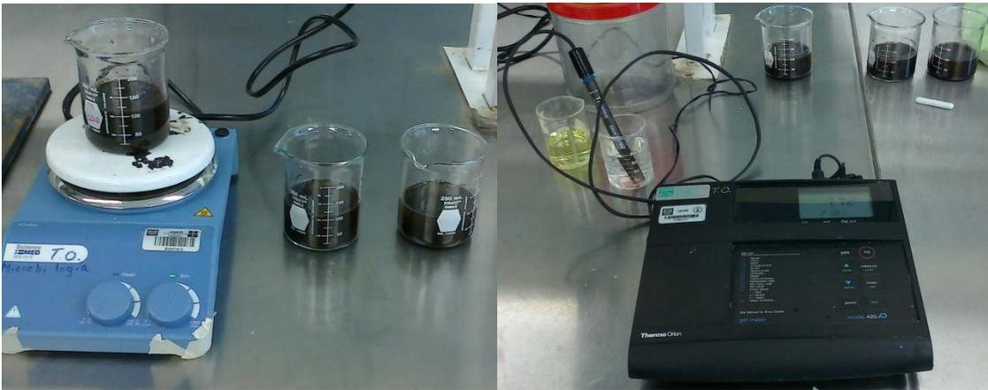
Figura 2.9 Determinación de pH
