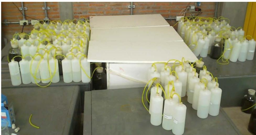
Figura 2.3. Sistema completo (24 reactores).
