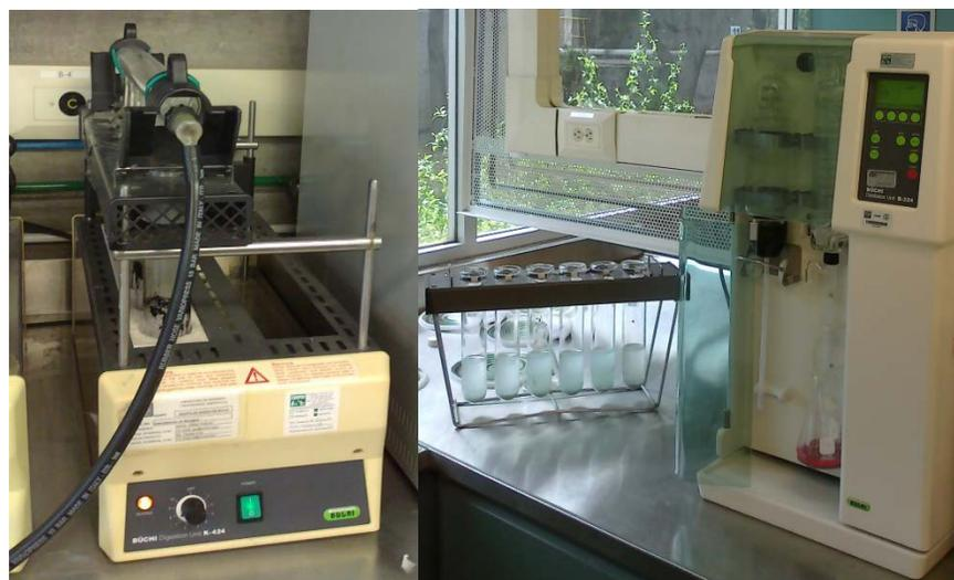
Figura 2.7 Sistema de digestión y destilación Büchi.
