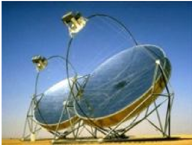
Imagen 3.4 Concentrador Schlaich, Bergermann and Partner de membrana tensionada facetada, extraída de http://www.solarenergytopics.com/solar/schlaich-bergermann-50kW.html
