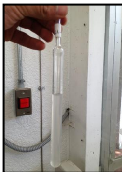
Figura 45. Solución de CS/NVCL contenida en una ampolleta de vidrio.
