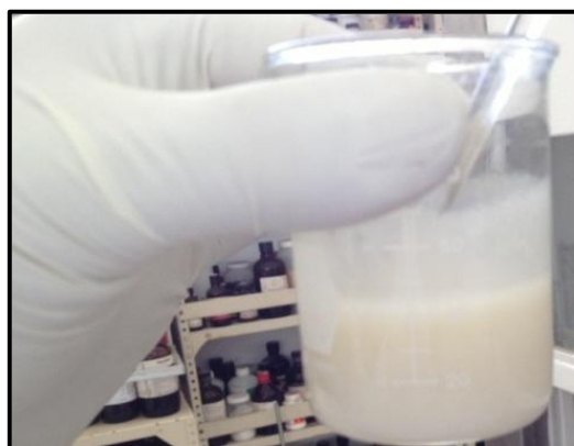
Figura 43. Disolución de CS y NVCL en ácido acético al 10% en agua.
