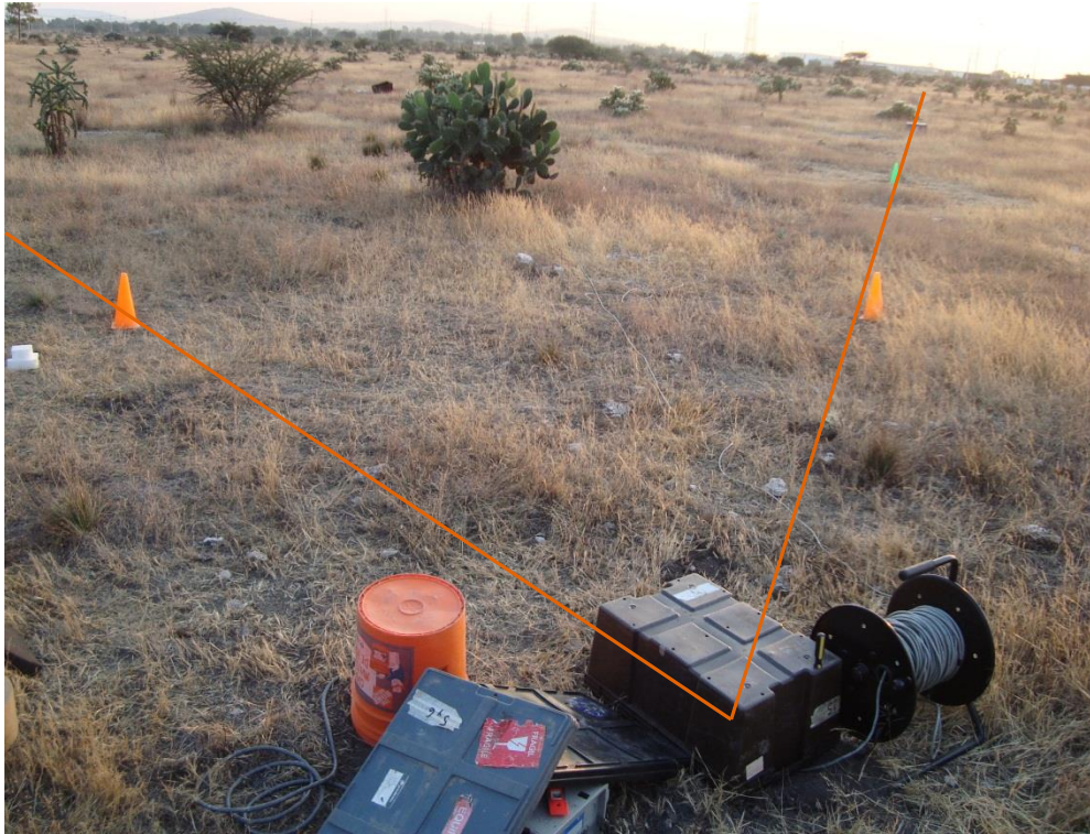
Figura 4.9. Arreglo grande de 200 m, en la Refinería “Miguel Hidalgo”.
