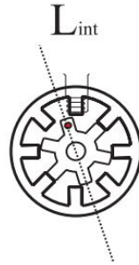
Figura A.5: Posición intermedia L_{int}
