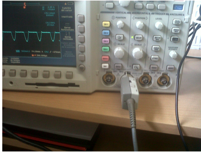
Figura 2.11: Montaje para la medición de corriente
