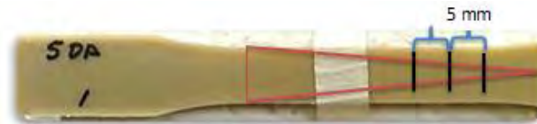
Figura 35. Ejemplo de cortes realizados en probeta para TEM.
