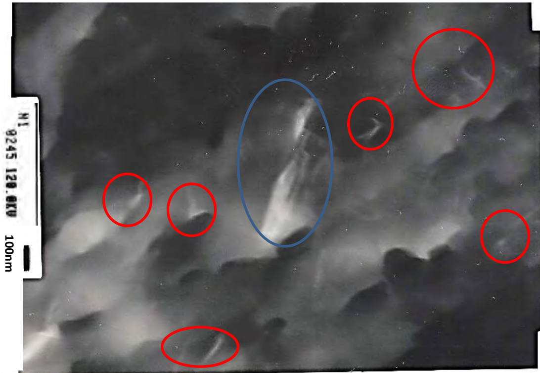
Figura 60. Imagen de la muestra 5% MMT-T con ABS nat obtenida por microscopía electrónica de transmisión, a una magnificación de 50Kx.
