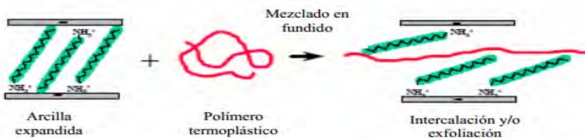
Figura 12. Representación esquemática del procedimiento de “mezclado fundido”, llevado a cabo para la preparación de nanocompuestos poliméricos.
