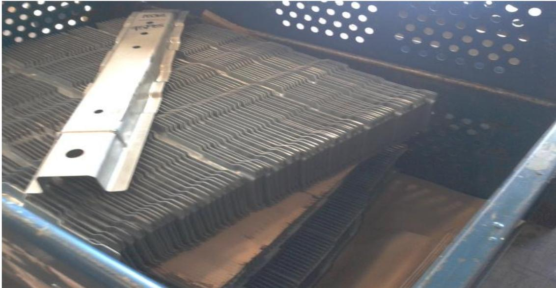
Esta pieza se llama longitudinal y son derechos e izquierdos los problemas principales que se presentan en estos componentes son que se revuelven y al estar en línea principal para su montaje se montan dos derechos o dos izquierdos ocasionando que la unidad no dimensione correctamente. y genere un paro en línea.
