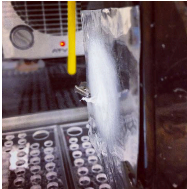
Figura 3.18 Andamio de PCL obtenido sobre colector de aluminio.
