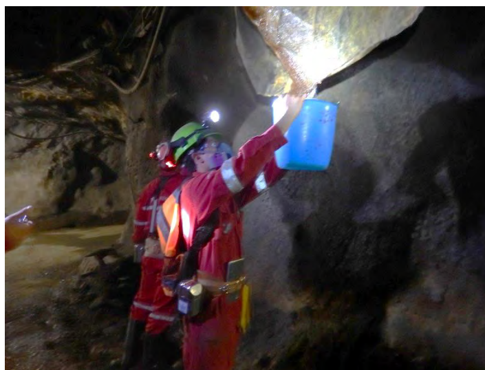
Figura 55. Uso de la cubeta como medio de captación
