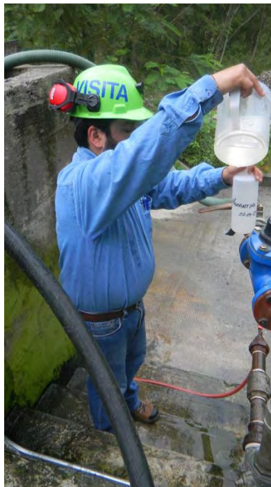
Figura 21. Toma de muestra de agua de manantial.
