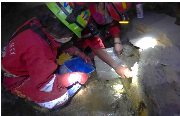
Figura 54. Medición de escurrimiento de DAM, haciendo uso de la bolsa de lona
