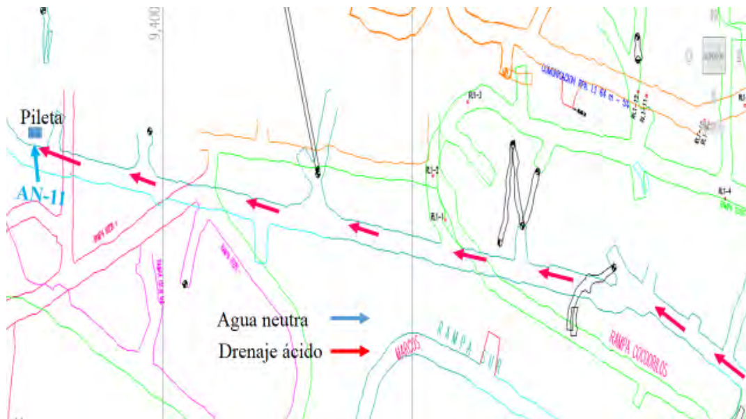
Figura 17. Ubicación del escurrimiento AN-11, sobre la rampa Sur.
