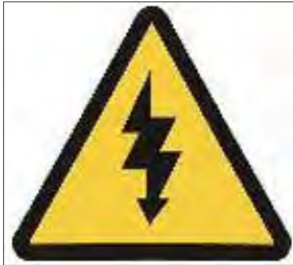
FIGURA 2.9. SEÑALES RESTRICTIVAS (ADVERTENCIA DE RIESGO ELÉCTRICO) (NOM-026, 2008).
