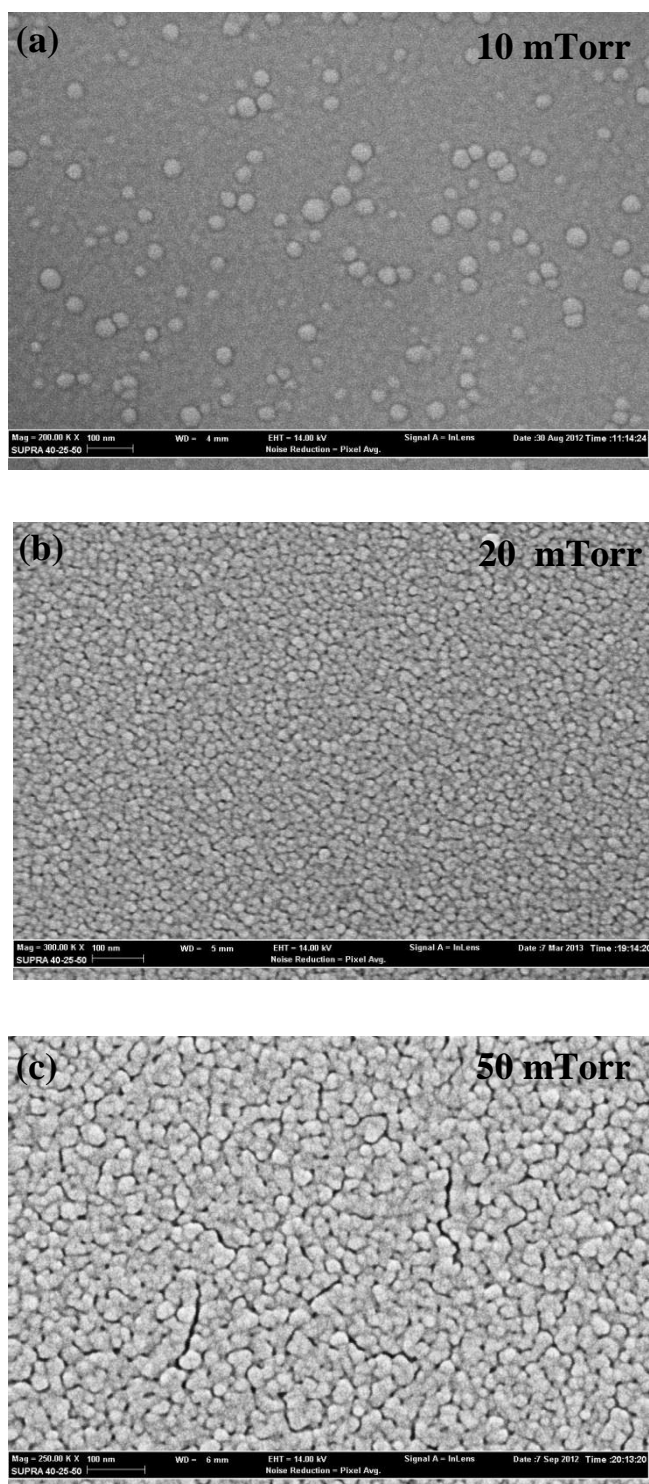
Figura 8. Depósito del ZnTe a presiones de. (a) 10 mTorr, (b) 20 mTorr y (c) 50 mTorr.
