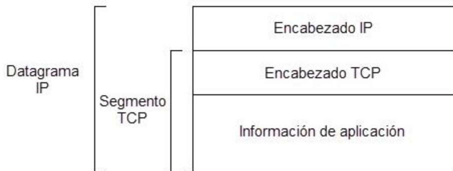
Figura 2.23. Estructura general del datagrama IP.
