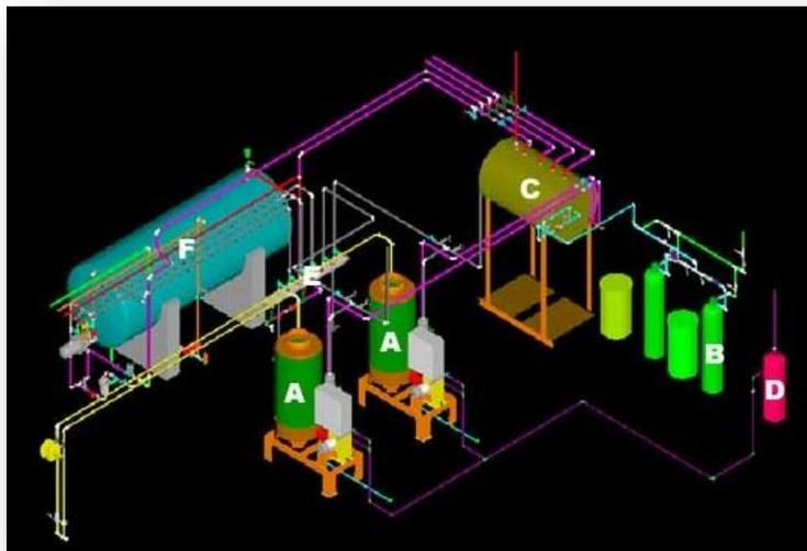
Figura 2.3: Isométrico de una estación de generación de vapor convencional
