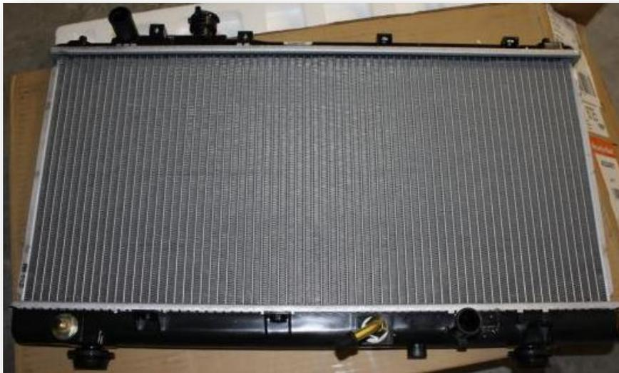
Figura 3.14: Radiador de aluminio soldado con níquel al vacío. (Fotografía cortesía de Ford Motor Company)
