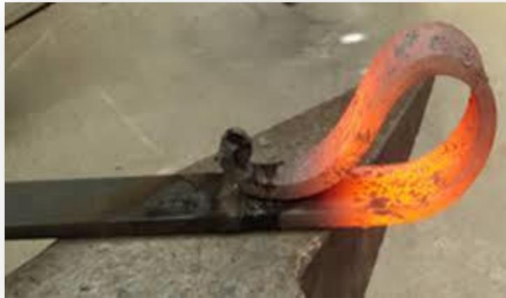
Figura 2.15: Ejemplo de conducción de energía.
