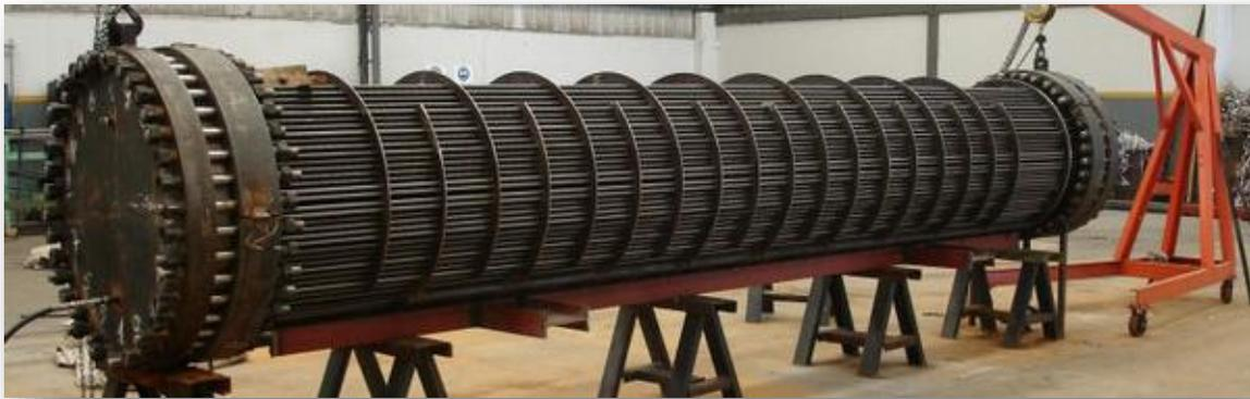
Figura 3.13: Haz de tubos de un intercambiador de calor con desviadores. (Fotografía cortesía de SICA S.A)
