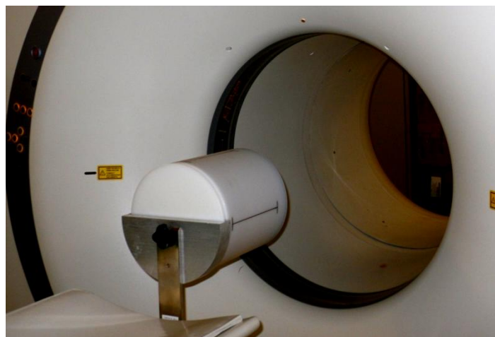
Figura 2.1 Fuente cilíndrica uniforme de ^{68}\text{Ge} colocada en el soporte para centrarla en el FOV de la cámara PET.
