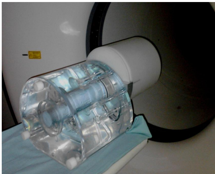
Figura 2.6 Colocación de los maniqués NEMA IEC Body Phantom y el maniquí rellenable en el FOV del PET.
