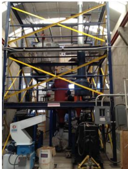
FIGURA 20. VISTA FRONTAL DEL GASIFICADOR DE BIOMASA DE CU
