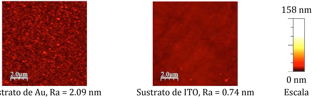
Figura 5.3.1. Imágenes por microscopia de fuerza atómica de los sustratos utilizados en el presente trabajo, ITO y Au.
