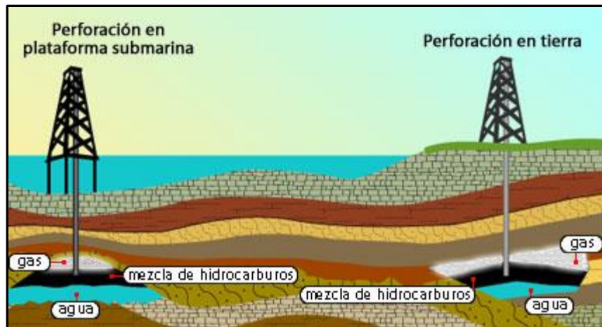
Figura 1-2 Esquema ejemplo de perforación en plataformas submarinas y perforación en tierra. ( http://laevolucionuniversal.blogspot.mx/ )
