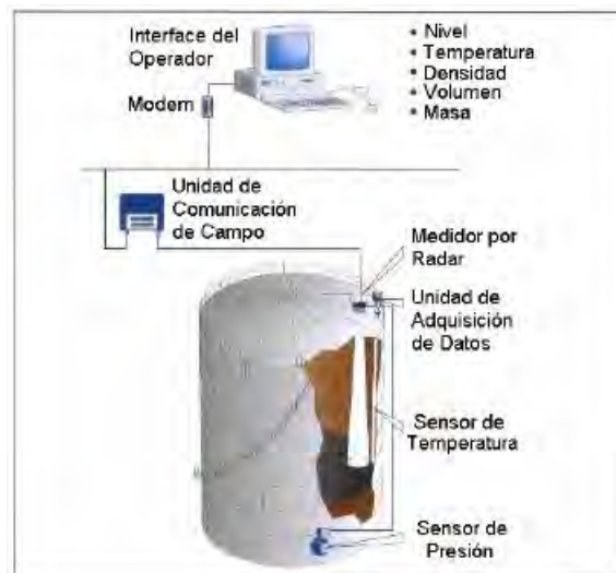
Figura 5.5 Esquema de colocación del medidor tipo radar
