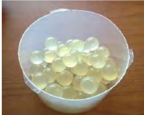
Figura 3.7 Agentes de bloqueo en las terminaciones multifractura
