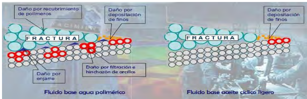
Figura 3.6 Esquematización de las diferencias entre los tipos de fractura
