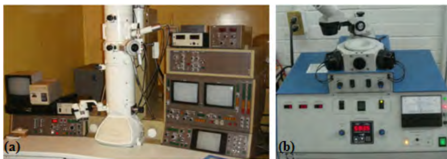
Figura 3.13 (a) Imagen del microscopio electrónico de transmisión empleado para el análisis y (b) imagen del equipo de bombardeo iónico en el cual se adelgazó la muestra.
