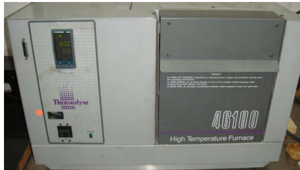
Figura 3.17 Horno donde se llevaron a cabo los tratamientos térmicos.
