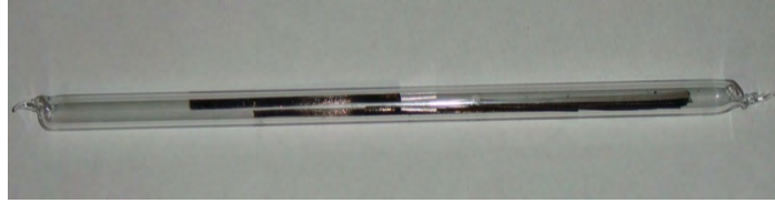
Figura 3.16 Imagen de la muestra encapsulada.
