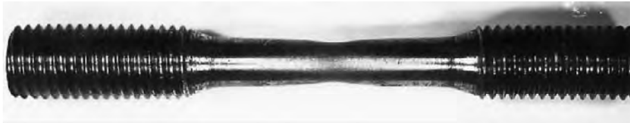
Figura 2.9 Estricción en una probeta de acero durante un ensayo de tensión [9].
