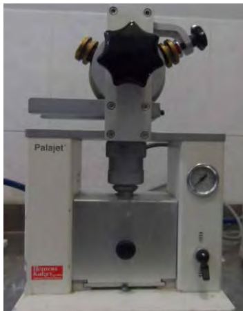
Imagen 16. Inyección de la resina PalaXpress® en el equipo de inyección PalaJet®.
