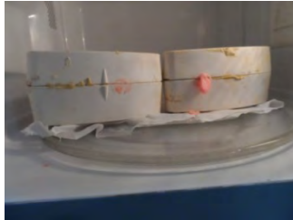
Imagen 20. Reblandecimiento y eliminación de la cera por medio de microondas.
