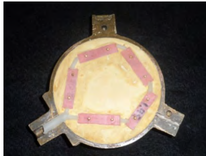
Imagen 12. Enmuflado inferior y colocación de los canales de inyección en las muestras en forma de barra.
