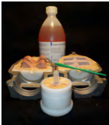
Imagen 6. Aislamiento de las superficies de yeso.
