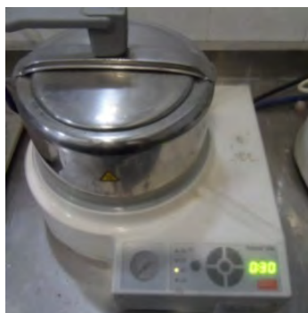
Imagen 17. Polimerización en la unidad PalamatPractic ELT®.
