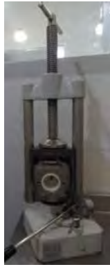
Imagen 9. Fijación de la mufla en la brida.
