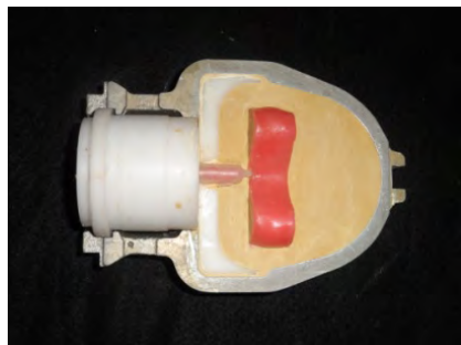
Imagen4. Colocación del embudo de inyección y de los canales de cera en las muestras de base protésica.
