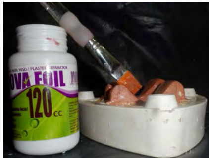
Imagen 20. Aplicación de separador yeso-acrílico.
